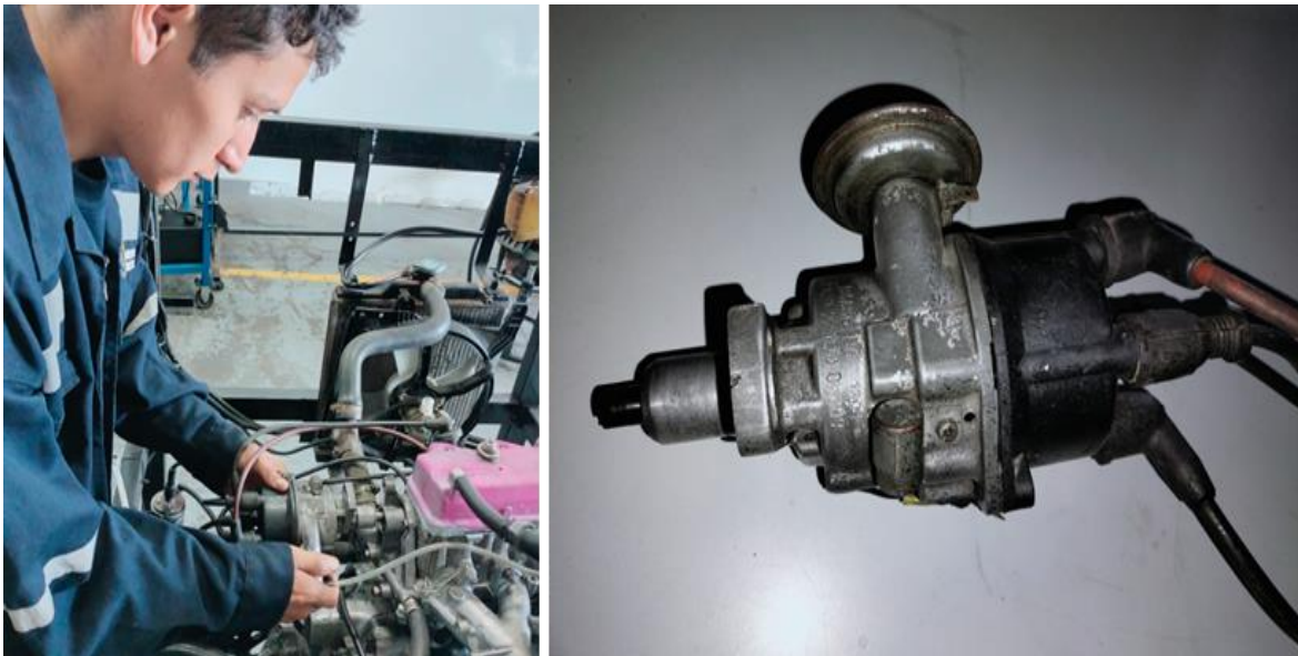
Figura 4. Extracción del distribuidor convencional
