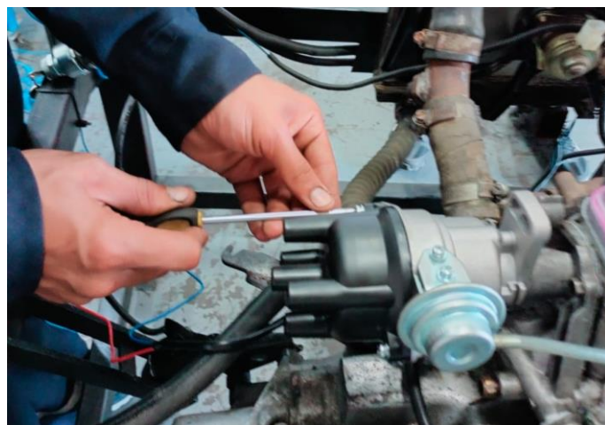
Figura 6. Ajuste de tapa de distribuidor electrónico.
