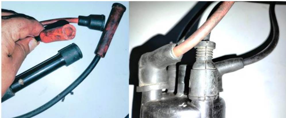
Figura 25. Cables de bujía del motor E16
