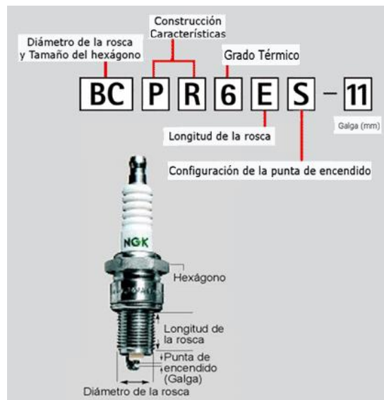
Figura 4. Nomenclatura de bujías.
