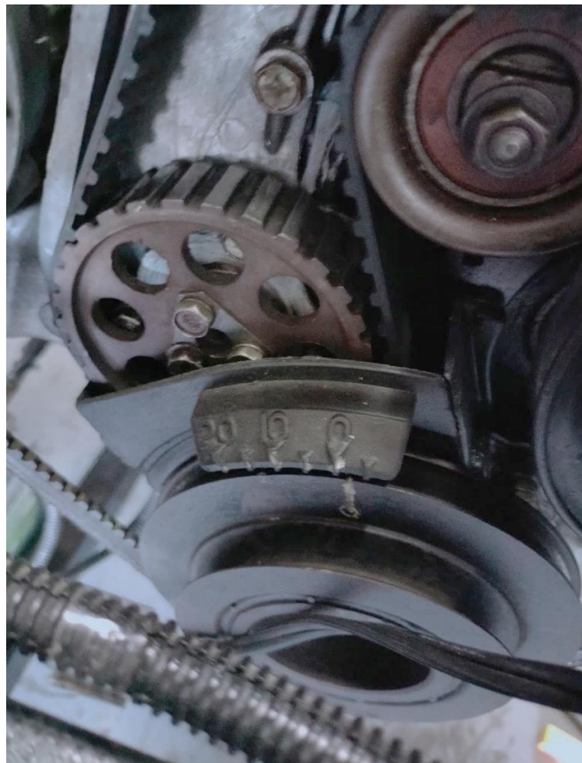
Figura 33. Punto de sincronización del sistema del encendido
