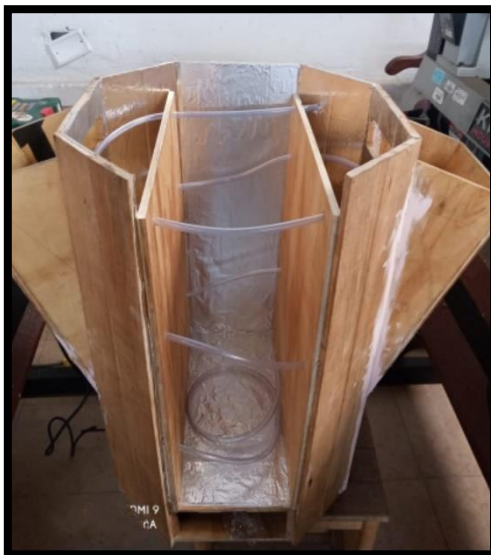
Figura 12: Instalación de sistema de aireación
