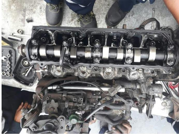
*Figura 15.* Desmontado la tapa de balancines
