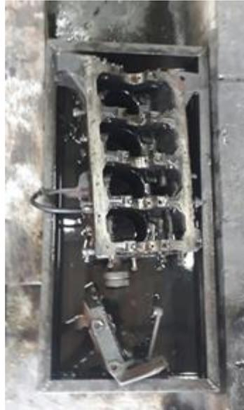
*Figura 18.* Lavado del bloque del motor
