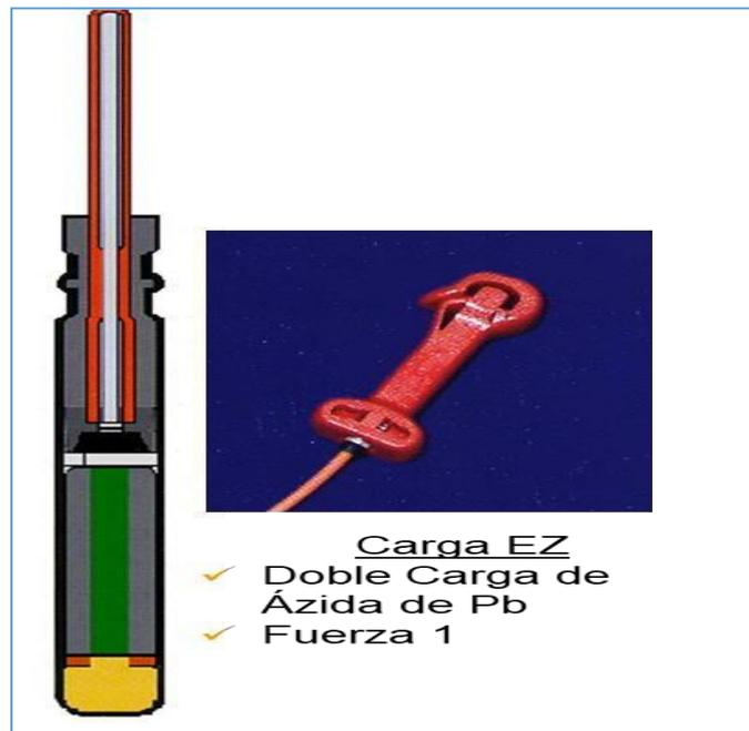
Figura N° 8. Componentes de Detonador
