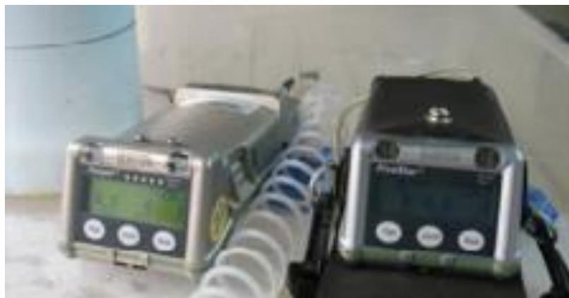
Figura N°21: Equipo para la medición de gases
