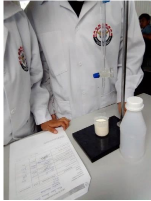
Imagen 18. Determinación de volumen de hidróxido gastado.
