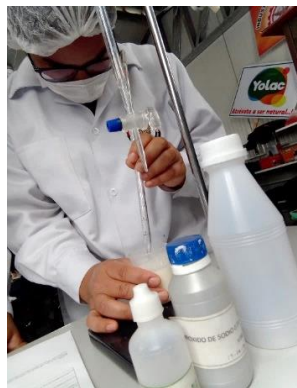
Imagen 17. Agregado de hidróxido hasta obtener color rosa
