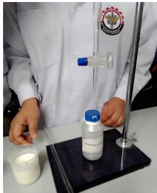
Imagen 16. Calibrado a cero del hidróxido en la pipeta.
