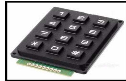
Figura 6. Teclado matricial para poner el número de pines requeridos.
