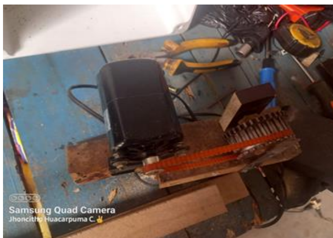
Figura 16. Sincronización de piñón de cigüeñal con motor mediante correa
