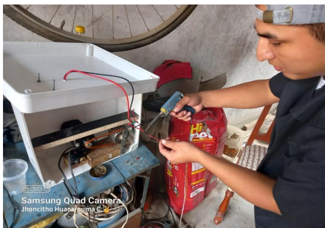
Figura.15. armado de la estructura del módulo de prueba de sensor CKP
