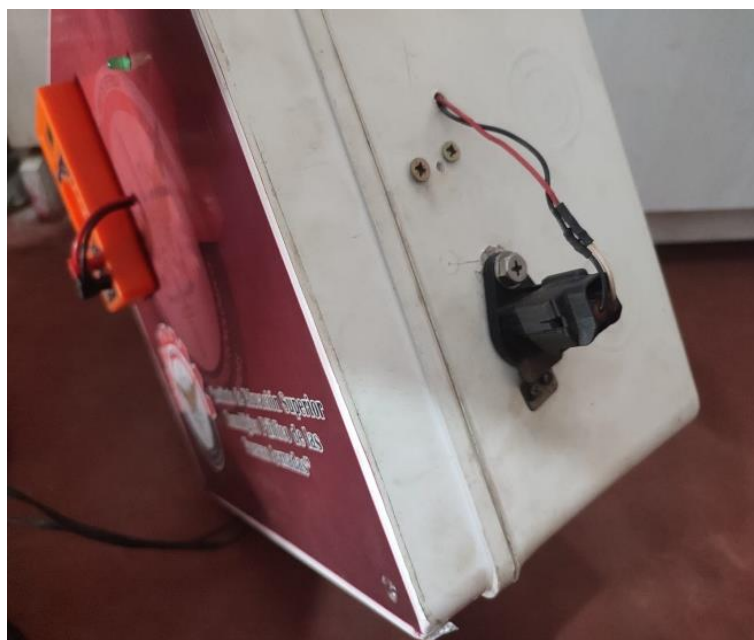
Figura.18. Conector estándar instalado para diagnóstico del sensor CKP
