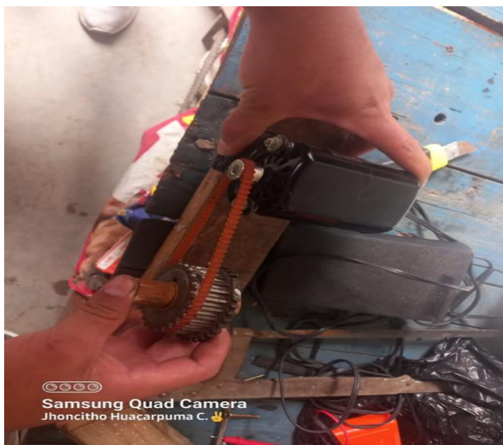
Figura 13. Ajuste, alineamiento del motor con respecto a la rueda fónica
