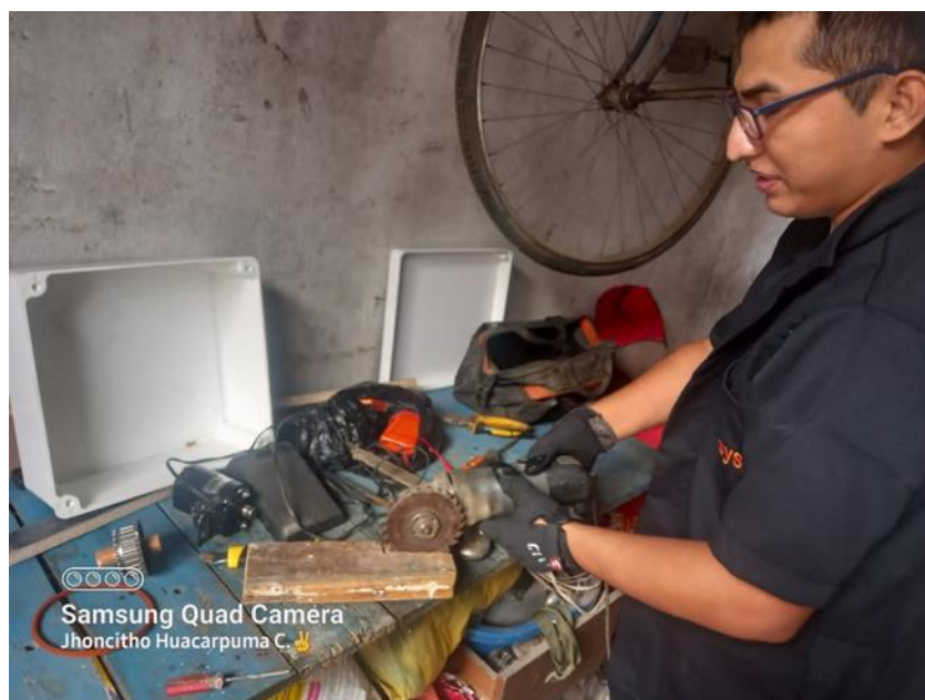
Figura 10. Corte de base para motor eléctrico
