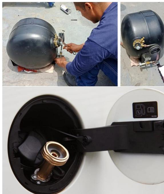
La válvula de cilindro está instalada en la cavidad del cilindro que permite controlar el abastecimiento, el sellado, fuga de emergencia por sobrecarga y cerrado manual del gas, de allí es llamado también multiválvulas o válvula multifuncional.
