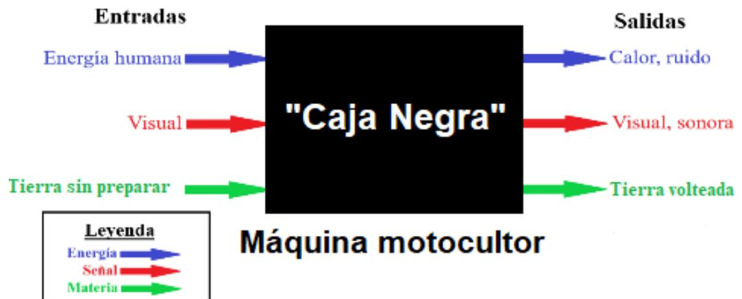
*Nota.* Caja negra, un diagrama de diseño para la máquina del motocultor para la visualización de las variables de entrada y salida de la máquina.
