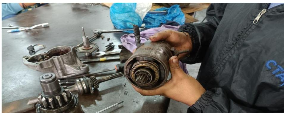
*Nota:* Sujetando el conjunto inductor e inducido del motor eléctrico.
