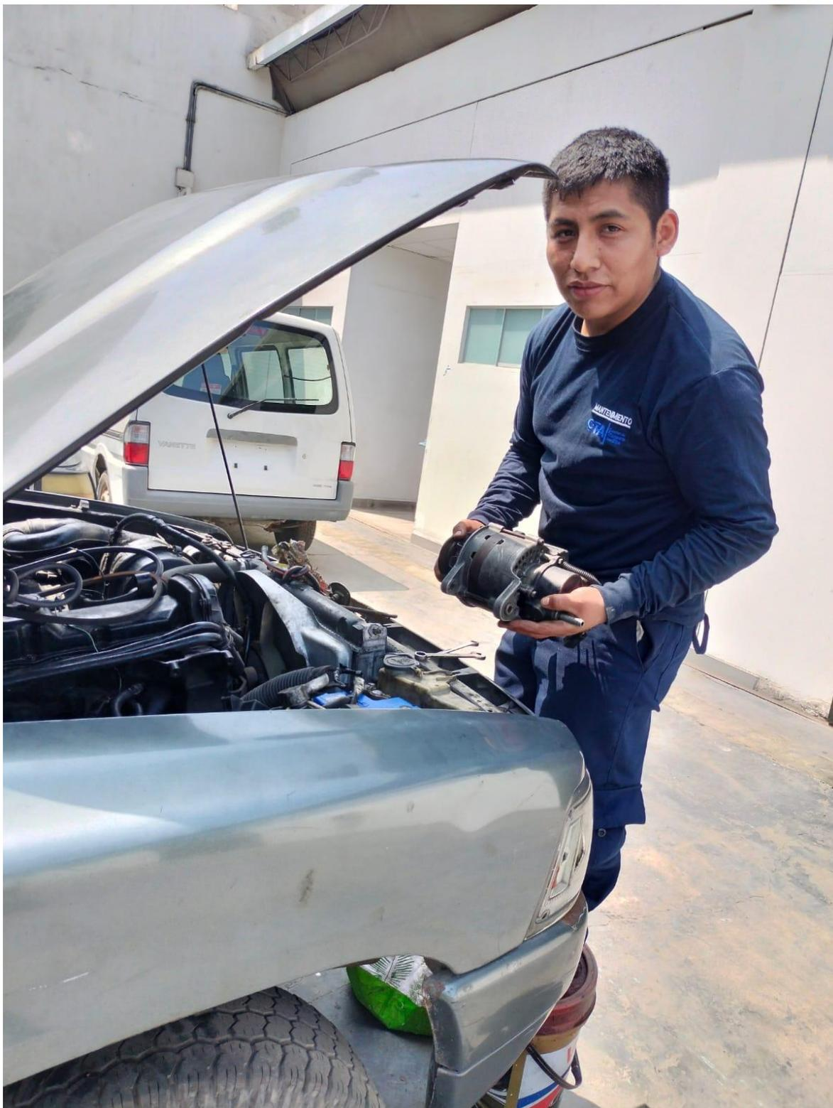
*Nota:* Muestra del alternador antes de ser acoplado al motor.
