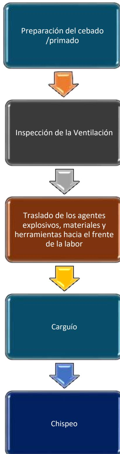
*Nota.* La voladura de rocas es la segunda actividad que permite fragmentar la roca en un frente de trabajo su proceso requiere un alto grado de capacitación en manipulación de explosivos [Imagen].
