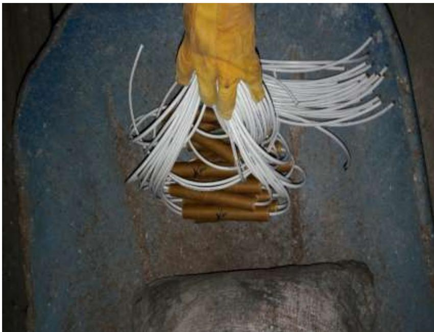
*Nota.* Muestra del cebado o primado de explosivo compuesto por mecha de seguridad, fulminante y dinamita [Fotografía], nov., 2021.
