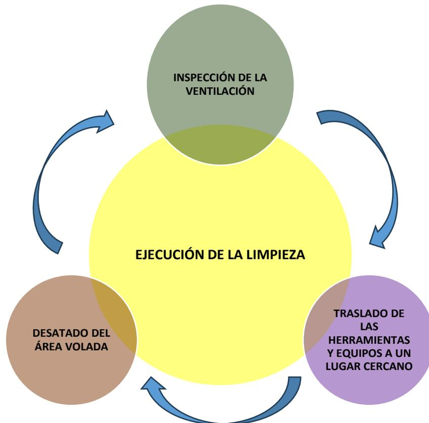
*Nota.* El proceso de la actividad de la limpieza empieza por la inspección de la ventilación, un momento clave que permite prevenir accidentes fatales, mediante mediciones a las concentraciones de gases presentes y que estas son evaluadas para la autorización del ingreso del personal [Imagen].
