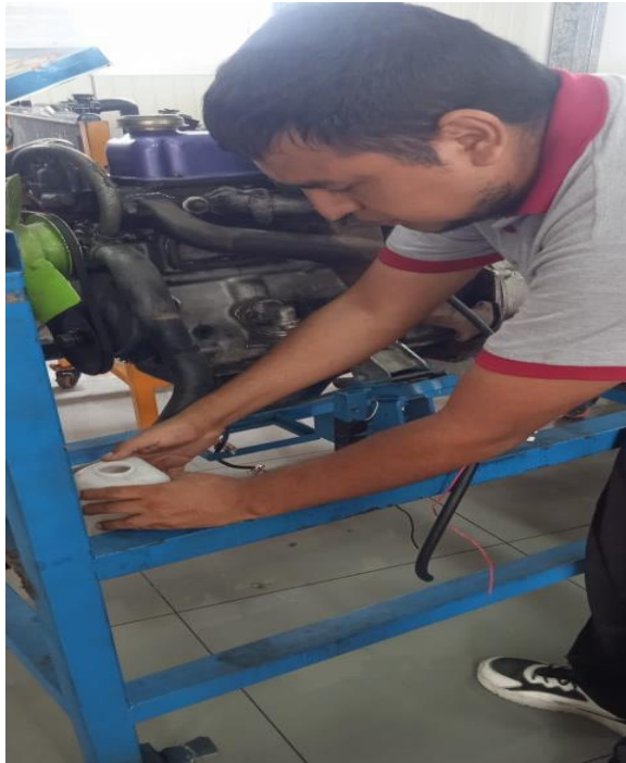
Fijación del depósito de combustible
