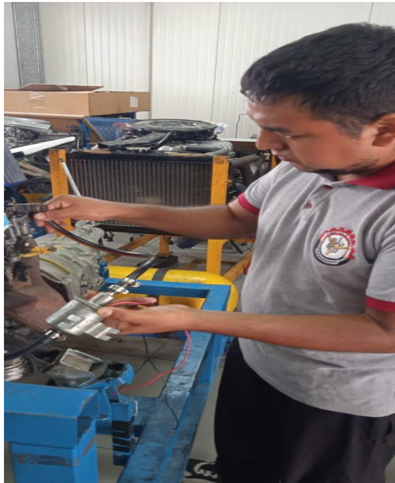
Bomba eléctrica de combustible.
