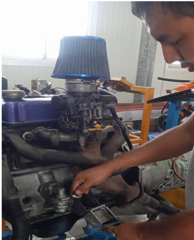
Bomba mecánica de combustible.
