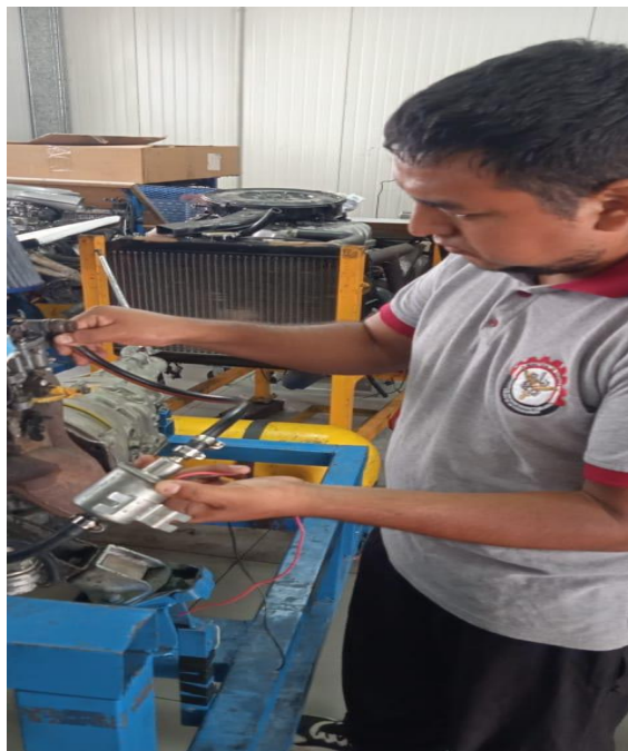
Instalación de la bomba eléctrica de combustible
