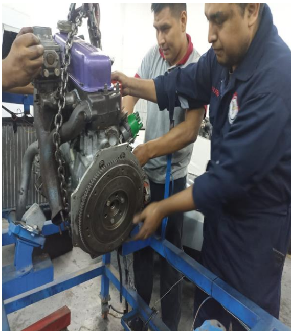
Desmontaje del motor
