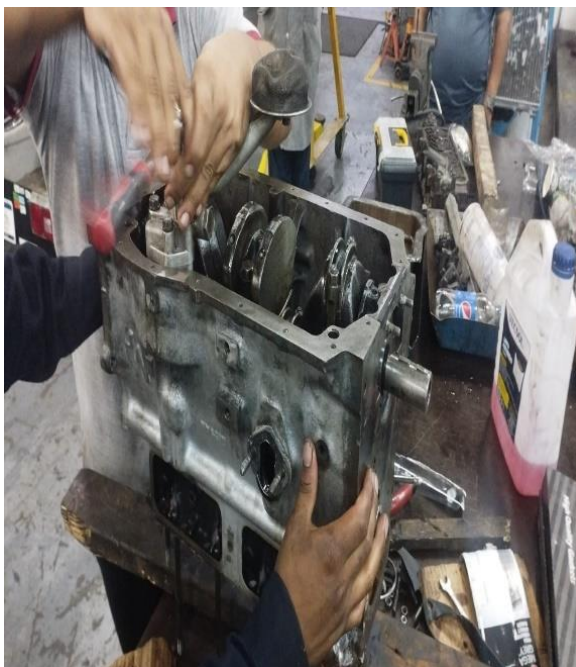
Desarmado del motor
