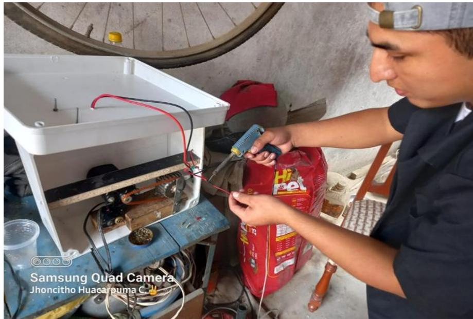
*Figura 16. Sincronización de piñón de cigüeñal con motor mediante correa*
