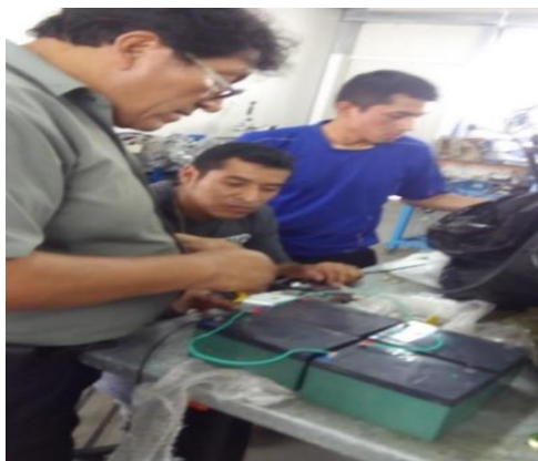
Figura 5. Instalación del circuito primario de cables + y -.
