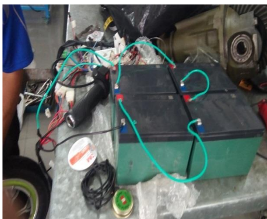
Figura 9. Prueba de encendido del motor eléctrico.
