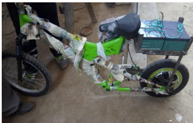
Figura 14. Baterías instaladas en la bici moto
