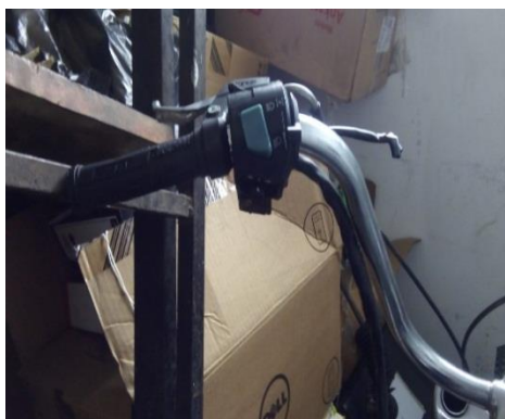
Figura 12. Acelerador electrónico instalado
