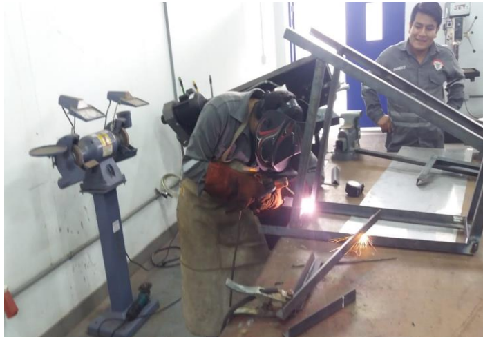
Figura 10. Soldado de la Base de la Roladora
