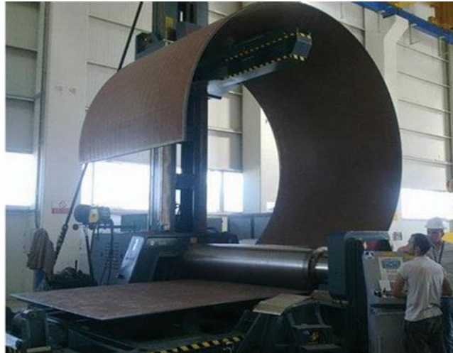
Figura 3. Rolado de tres rodillos de una lámina
