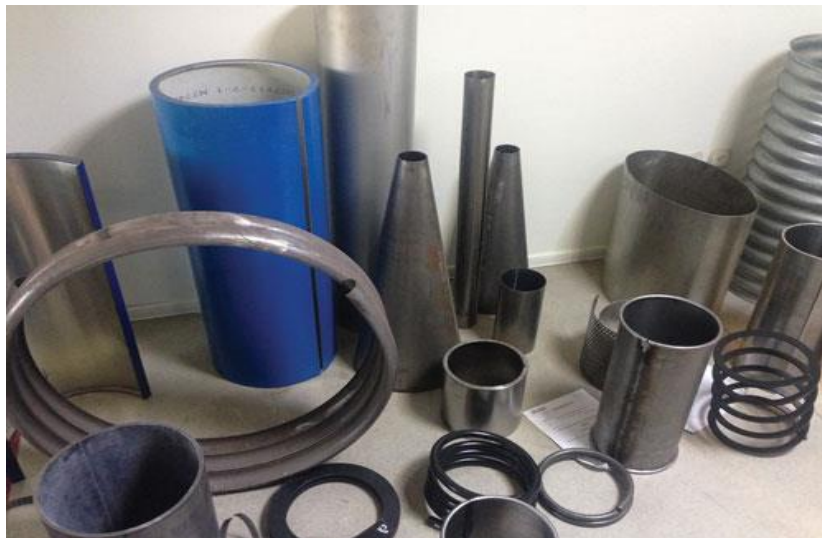
Figura 9. Rolado de tres rodillos de una lámina
