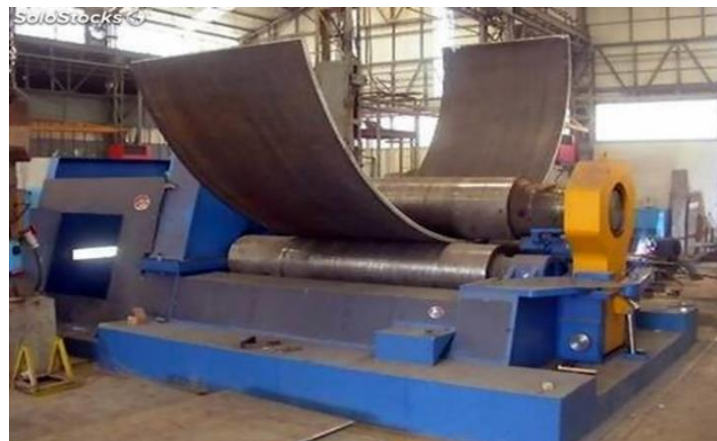
Figura 2. Rolado de tres rodillos de una lámina
