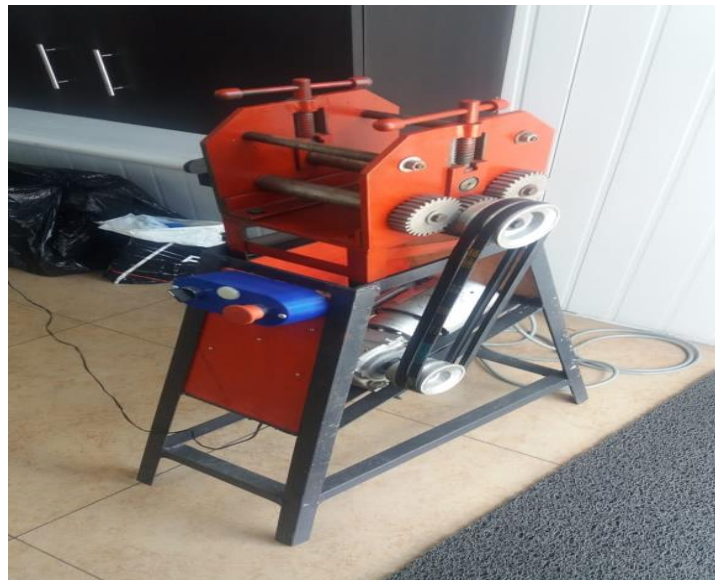
Figura 17. Estructura acabada de la Roladora.
