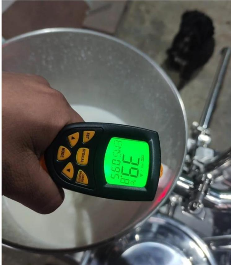
Se observó que la diferencia de temperatura con el controlador de temperatura es mínima, 2 grados centígrados de diferencia.
