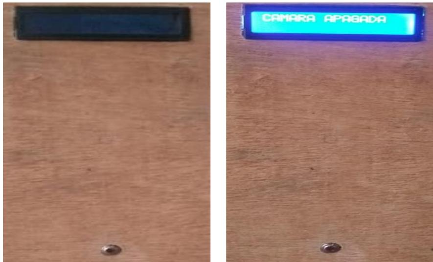
*Figura 45.* Estado de la pantalla lcd cuando está desactivado y activado
