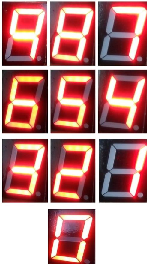
*Figura 54.* Funcionamiento del Display de 7 segmentos descontando del 9 al 0
