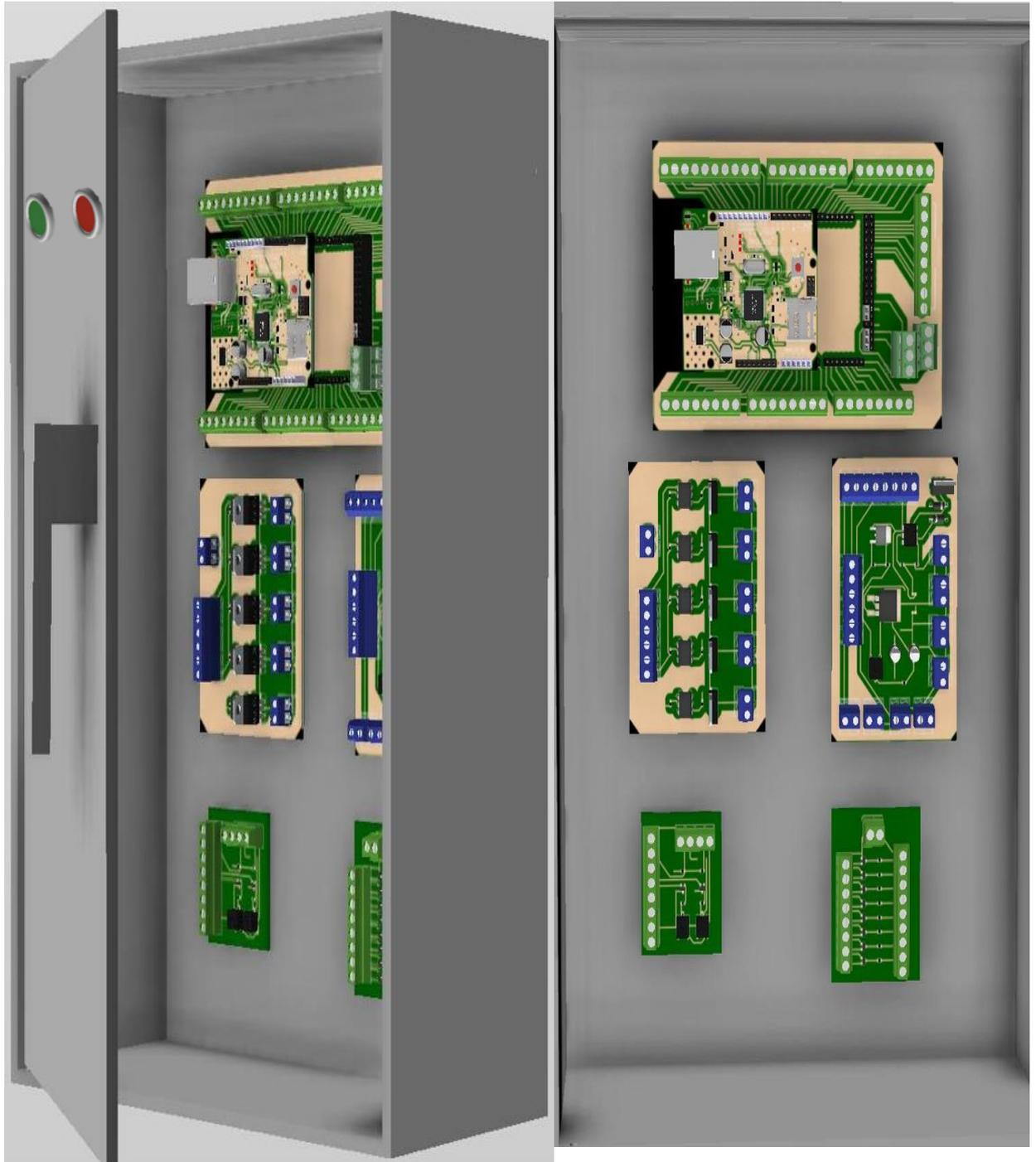
*Figura 43.* implementación de los circuitos electrónicos al tablero general
