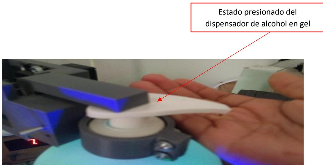
*Figura 58.* Dispensador de alcohol en gel activado y dosificando alcohol en gel
