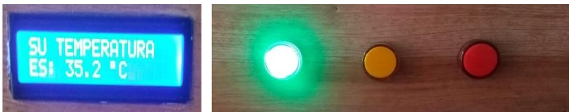
*Figura 48.* Luz de señalización verde activada debido a que la temperatura de la persona es adecuada
