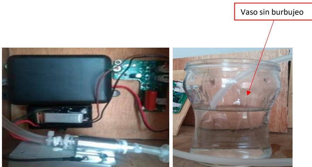
*Figura 55.* Generador de ozono desactivado
