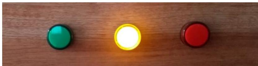
*Figura 49.* Luz de señalización amarilla activada debido a que una persona está dentro de la cámara
