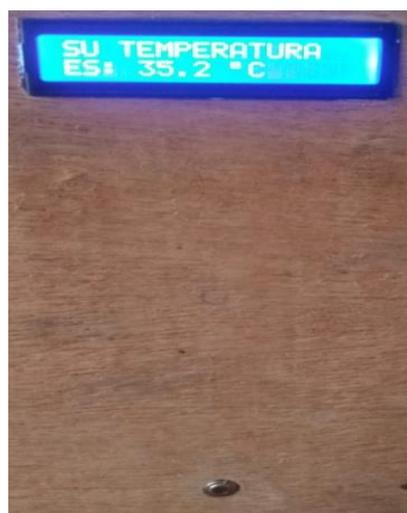
*Figura 46.* Estado de la pantalla lcd y del sensor temperatura cuando está en funcionamiento en la toma de temperatura
