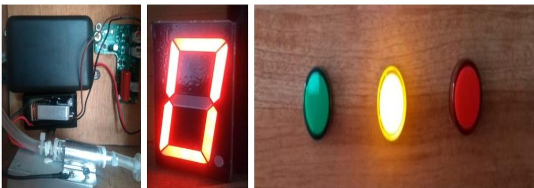
*Figura 52.* Activación del generador de ozono, display de 7 segmentos y luz amarilla Al detectar el sensor laser de entrada a una persona
