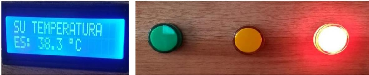
*Figura 50.* Luz de señalización roja activada debido a que la temperatura de la persona no es adecuada
