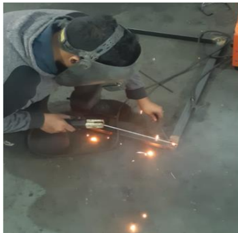
Figura 33. Unión con soldadura los tubos.
