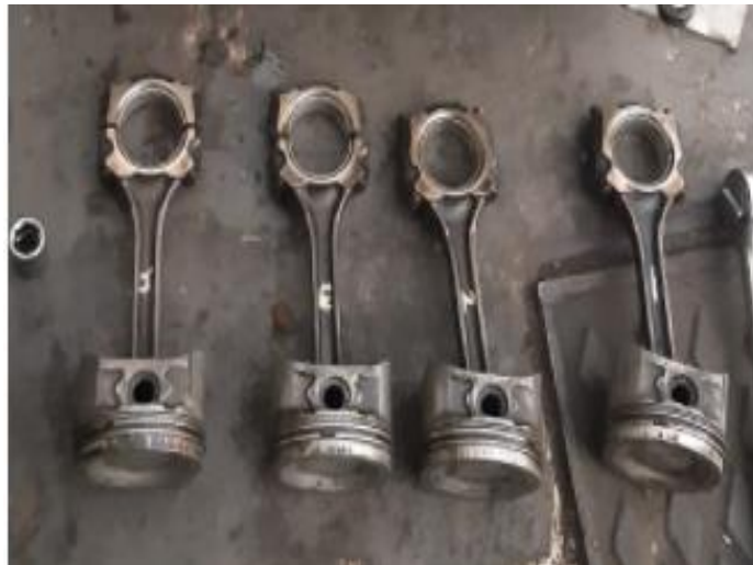
Figura 39. Lavado de pistones
