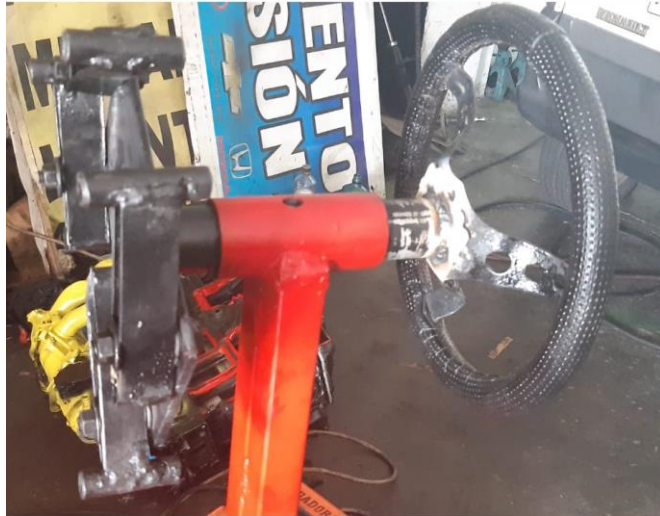
Figura 36. Colocado de soporte de motor
