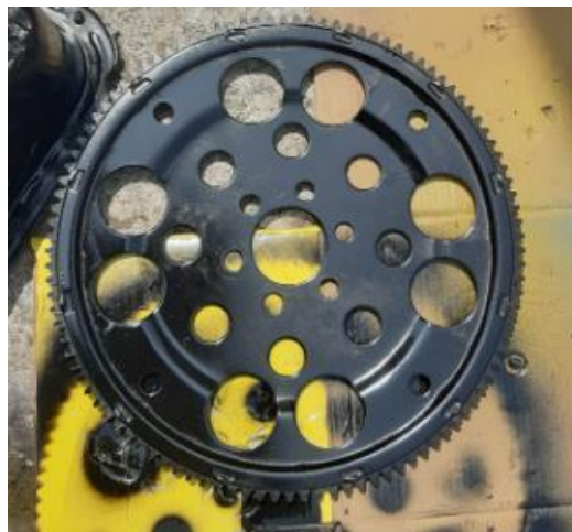
Figura 29. Pintado de la volante.
