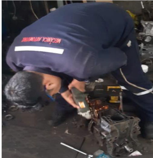
Figura 19. Emparejando con piedra de desbaste
