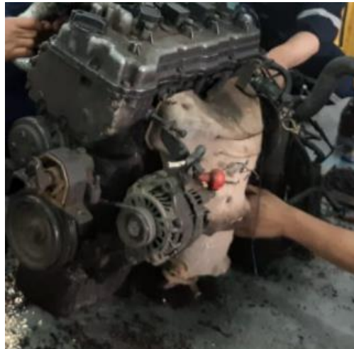
Figura 13. Desmontando el múltiple de escape
