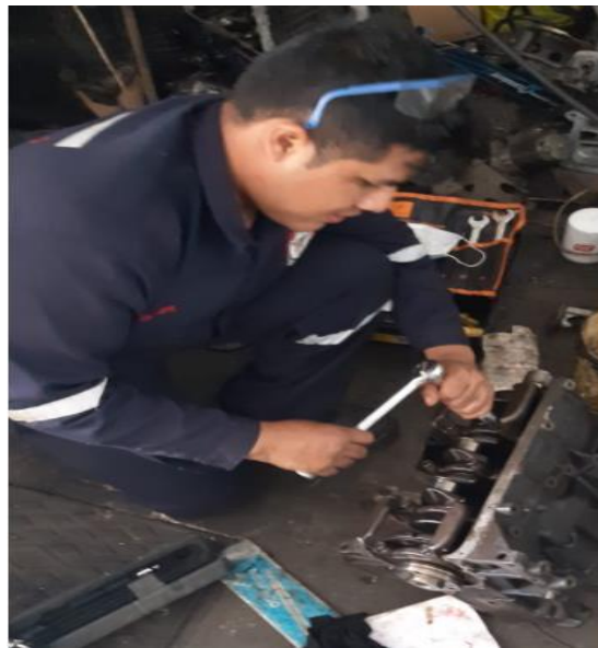
Figura 41. Colocado de la bancada y ajustado
