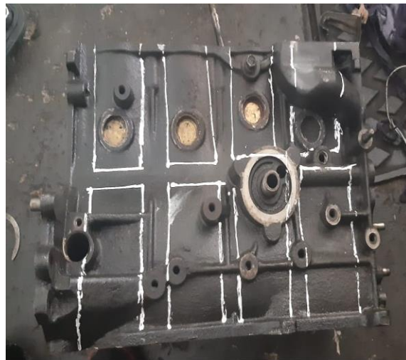
Figura 17. Trazos para el corte
