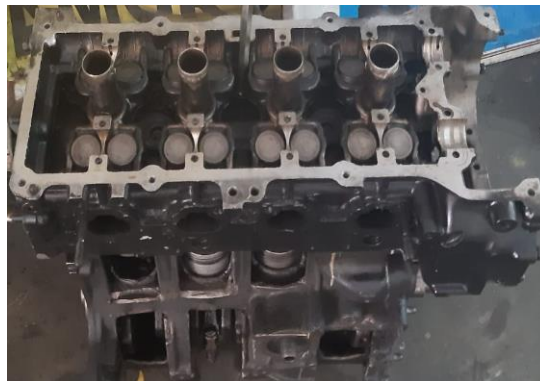
Figura 47. Montado la culata
