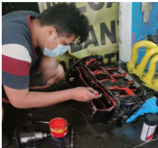
Figura 24. Pintado las ventanas del bloque y cárter
