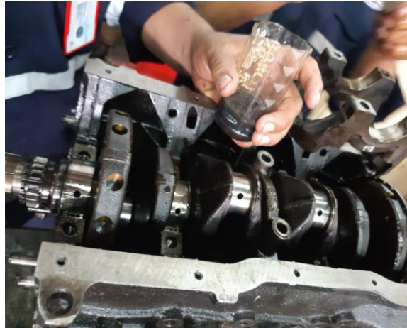
Figura 16. Lubricado de piezas
