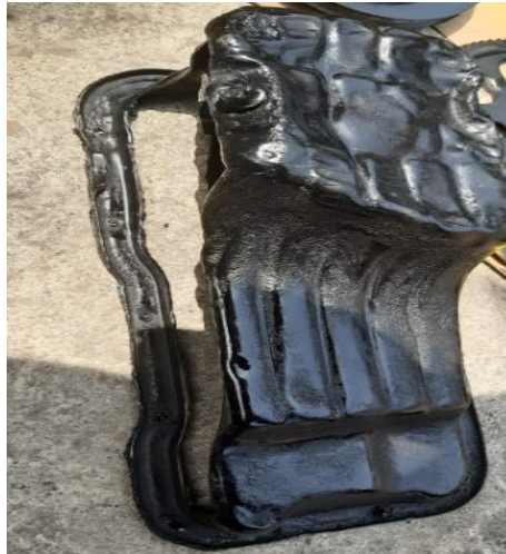
• Figura 26. Pintado del cárter
