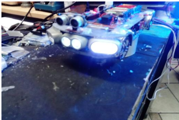
Figura N° 22. Prueba de encendido de los focos LEDS.
