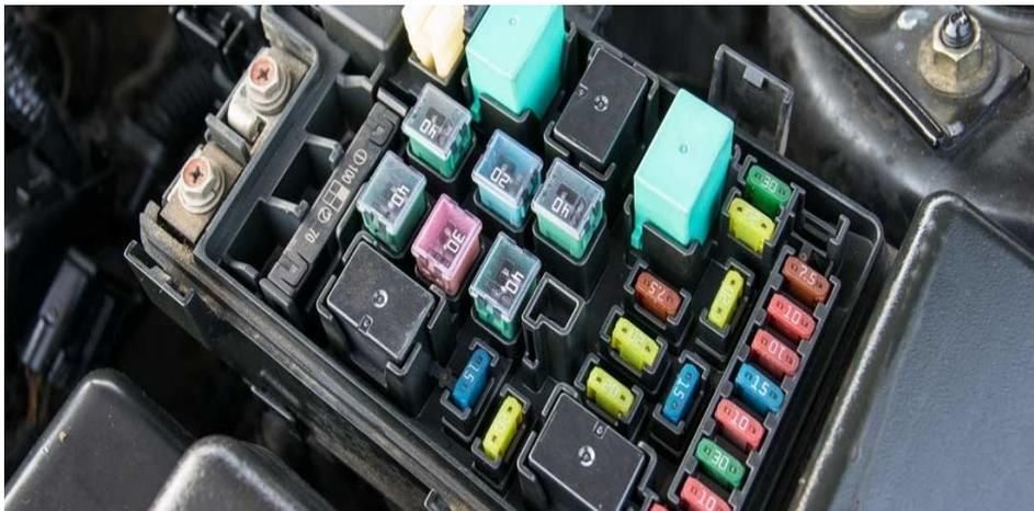
*Figura N° 16. Caja de fusibles*
