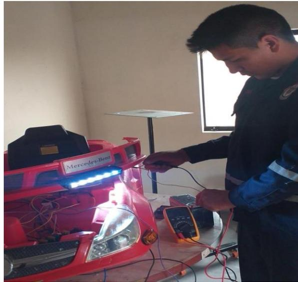
Figura N 21: Comprobación de los circuitos de antiniebla
