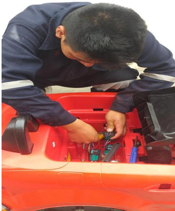
Figura N° 24: Instalación de direccionales
