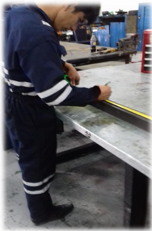
Figura N°13. Habilitación material para construcción armado de chasis
