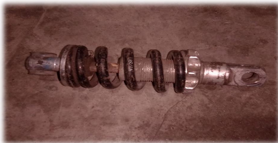
Figura N° 12: Amortiguador regulable adaptado en chasis secundario
