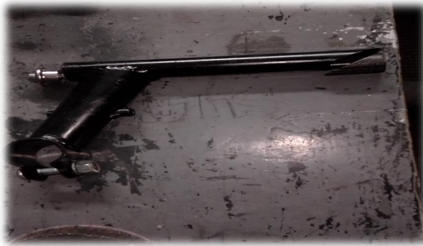
Figura N°11: Chasis secundario diseñado para la bicimoto.
