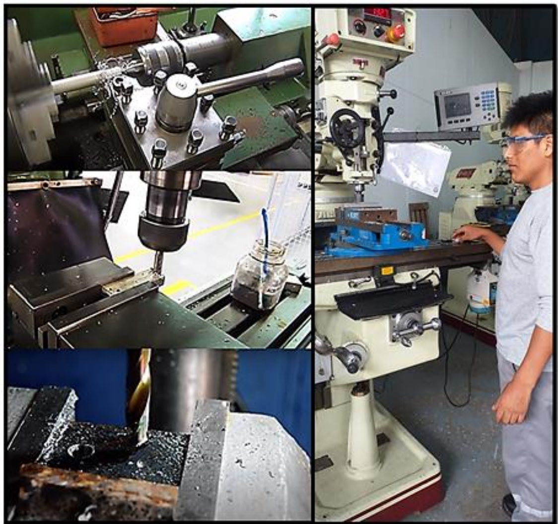
Figura 68. Fabricación mecánica de pasadores de trabar para puerta abatible
