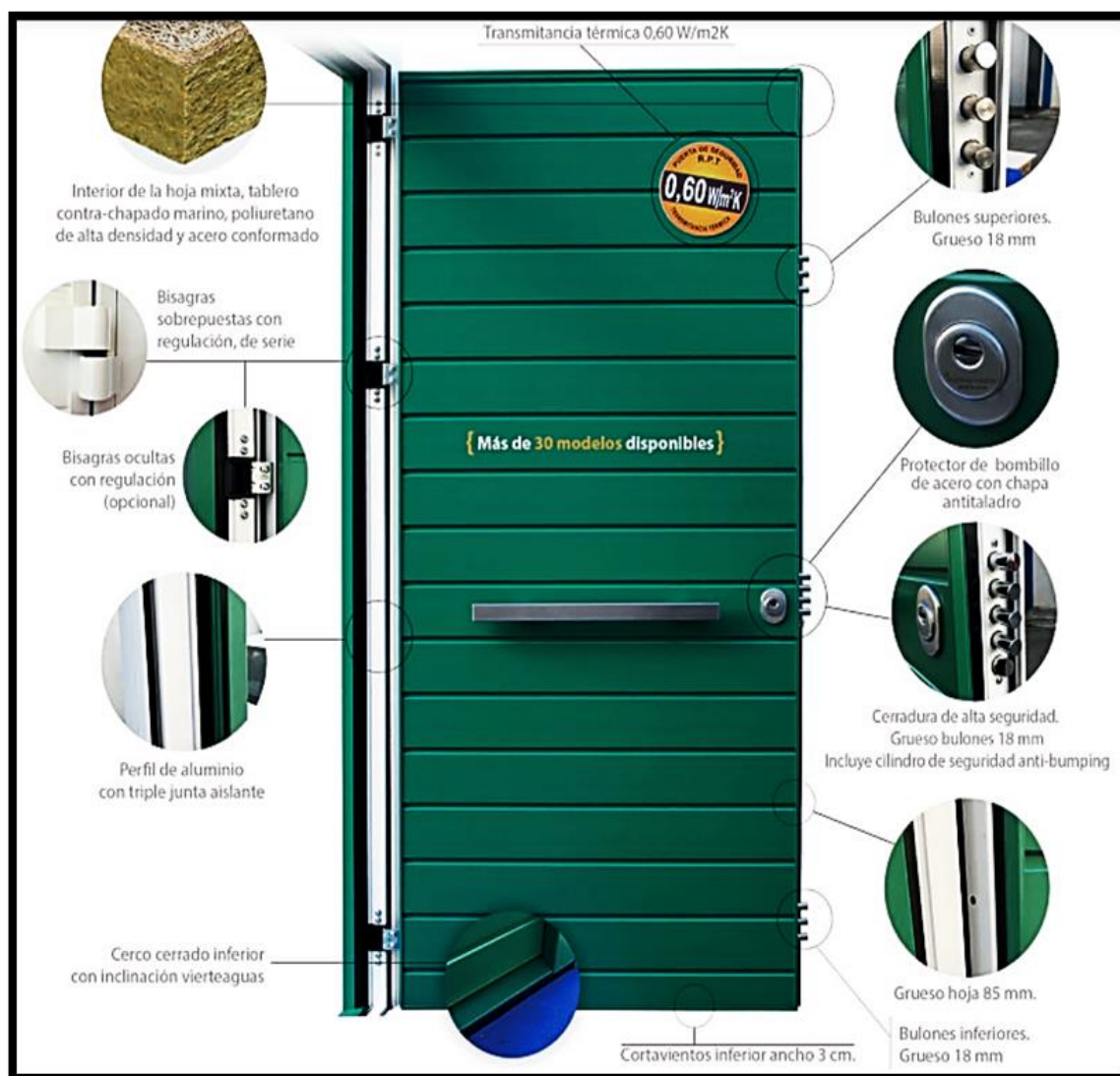
Figura 30. Puerta de seguridad con rotura puente térmico
