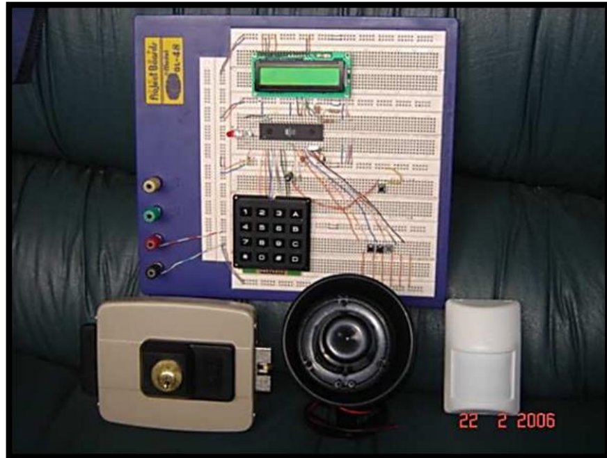
Figura 2. Elementos que conforman un sistema de cerradura electrónica digital
