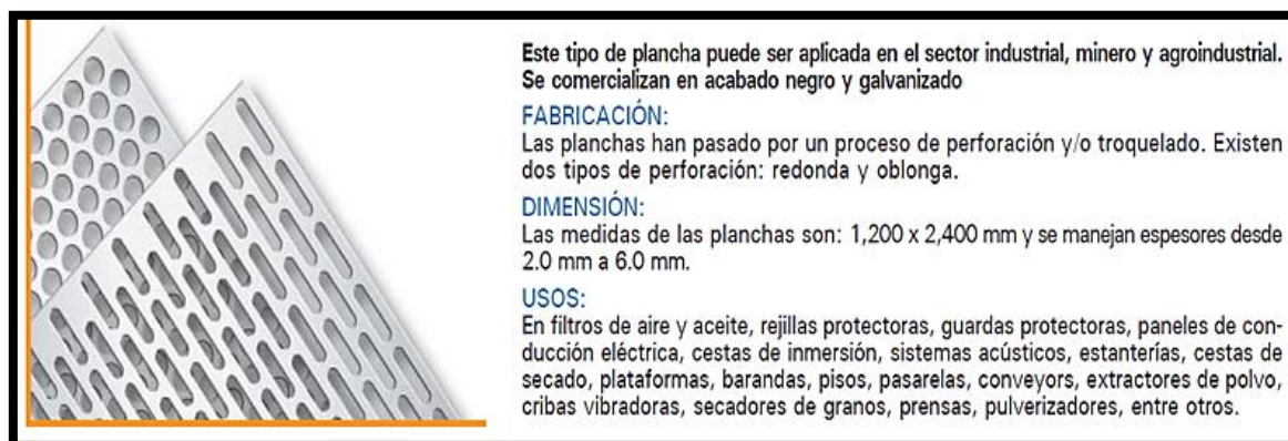
Figura 40. Lámina perforada de acero, barrenos oblongos
