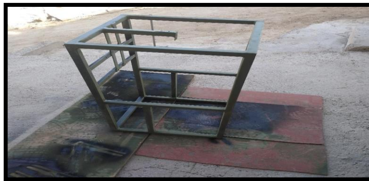
Figura 39. Recubrimiento con anticorrosivo a la base rectangular y elementos.
