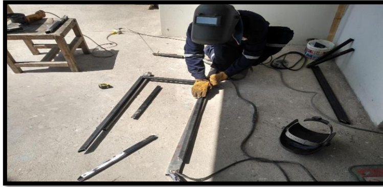
Figura 35. Soldando los perfiles rectangulares.
