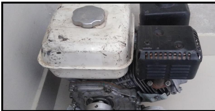
Figura 28. Tanque de combustible para el motor.
