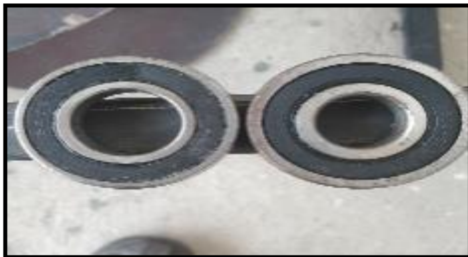
Figura 31. Rodajes como soporte y guía.
