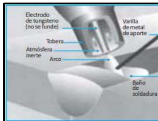
Figura 43: Proceso de Soldadura TIG (Soldexa, 1981, p.31).
