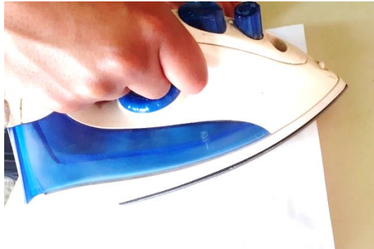
Figura 16. Transferencia del papel couche a la PCB.
