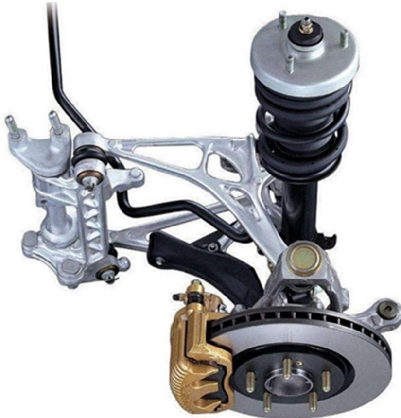
*Nota:* Suspensión independiente doble horquilla trasero de la marca Honda 2002. Tomado de *Técnica: sistemas de suspensión*, de Espíritu RACER. (s.f.), <https://espirituracer.com/archivos/2018/11/12-Paralelogramo-deformable-eje-trasero-Honda-NXS.jpg>
