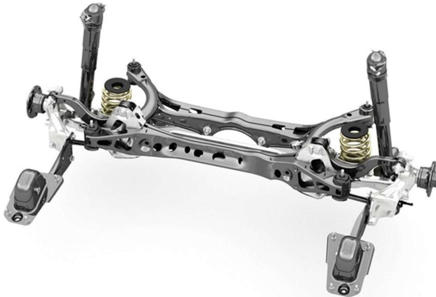
*Nota:* Estructura de la suspensión semirrígida en forma de “H”. Tomado de *¿Cómo funciona el sistema de suspensión rígida y semirrígida?*, de Flavio., s.f. <https://como-funciona.org/como-funciona-el-sistema-de-suspension-rigida-y-semirrigida/>
