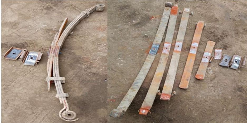
*Nota:* En esta parte se muestra el despiece de hojas del paquete de ballesta para evaluar el estado de conservación y ejecutar los procesos para el mantenimiento correctivo.
