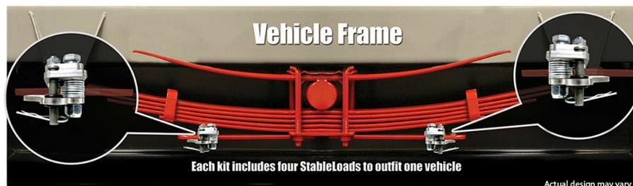
*Nota:* Propuesta comercial con la instalación de un paquete de hojas agregando la hoja auxiliar (“overload”) visto en la parte superior del grupo. Tomado de *StableLoad Suspension Upgrade (Lower Overload Application)* de Torklift International. (2023, 2 de febrero). <https://www.torklift.com/products/suspension/stableload-lower-overload?highlight=WyJ2aWRlbyIsInZpZGVvcyJd>
