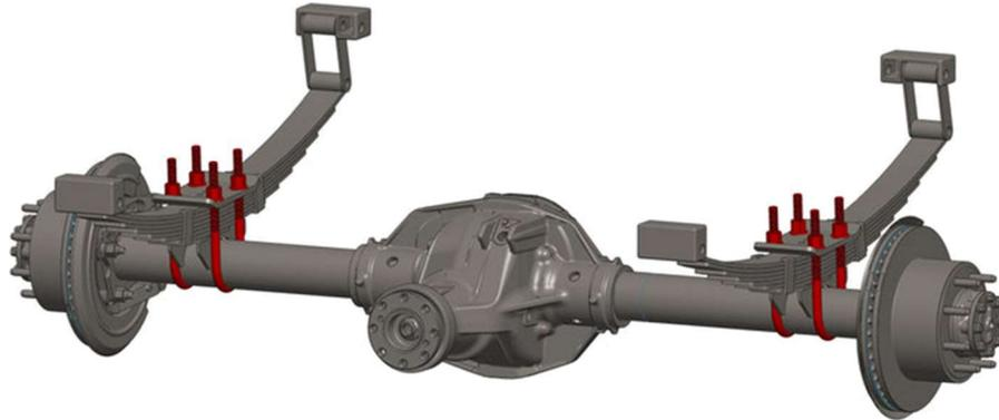
*Nota:* Configuración leaf spring rigid axle de la suspensión posterior, donde el paquete de hojas está ajustado con abrazaderas tipo "U" en el puente de transmisión rígida del vehículo. Extraído de [https://www.tnrcustoms.com/cdn/shop/files/1359\\_REV1\\_WEB3red\\_720x.jpg?v=1752857413](https://www.tnrcustoms.com/cdn/shop/files/1359_REV1_WEB3red_720x.jpg?v=1752857413)
