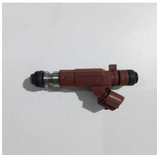
*Figura 12.* Inyector de gasolina
