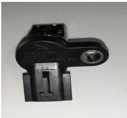
*Figura 2.* Sensor de posición del cigüeñal
