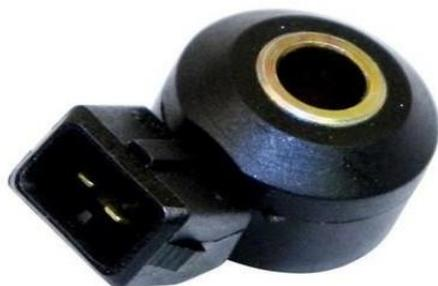
*Figura 4. Sensor de detonación o de picado*
