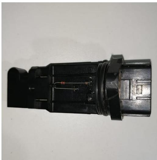
*Figura 7. Sensor de temperatura de aire*
