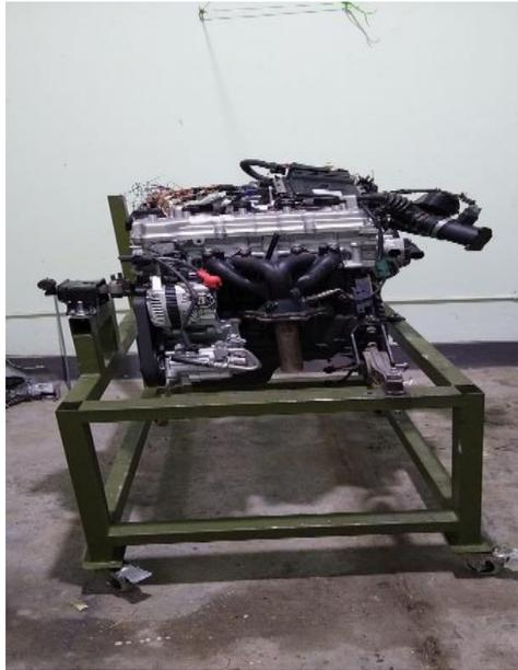
*Figura 23.* Montaje del motor en la estructura.
