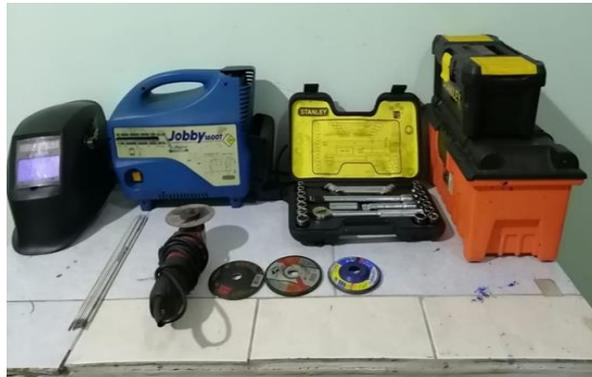
Figura 17. Máquina de soldar, amoladora, discos de desbaste y corte.
