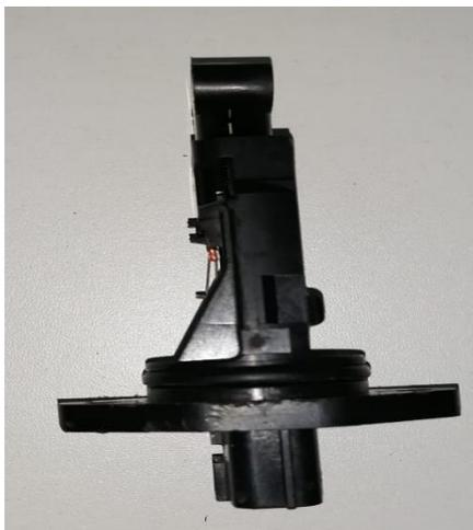
*Figura 6.* Sensor de Medidor de flujo de masa de aire
