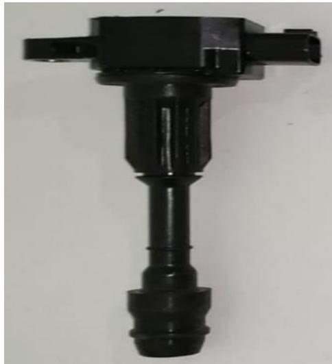
*Figura 14.* Bobinas de encendido
