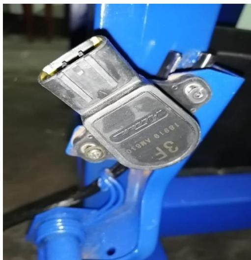
*Figura 5.* Sensor de posición del pedal del acelerador
