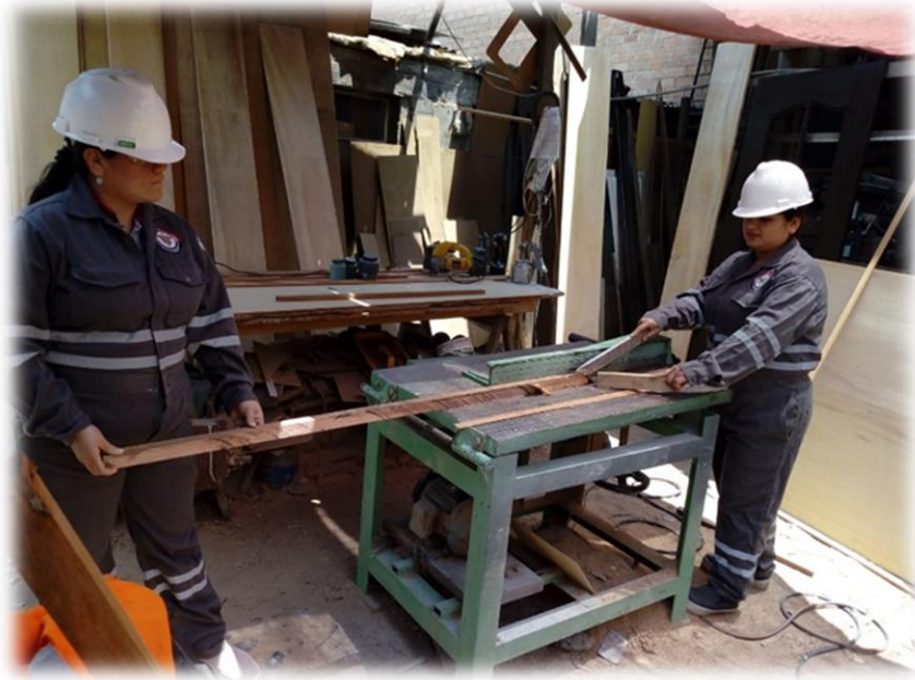
Figura 35: Dimensionado de la madera en la máquina de sierra de disco (Corte longitudinal).
