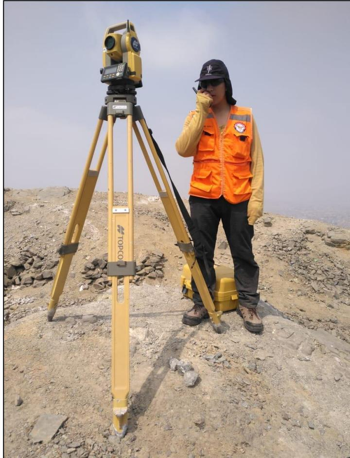
Foto 06: Se visualiza al topógrafo con el equipo instalado, con su radio avisando al asistente que iniciara a tomar la data de la trocha carrozable.
