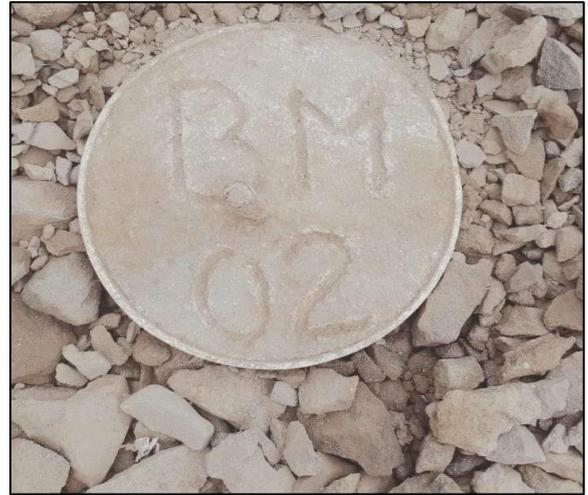
Foto 01 y 02: Observamos los dos BM (BM 01 y BM 02), en donde se entrelazo los puntos iniciales al trabajo de aplicación profesional para la trocha carrozable
