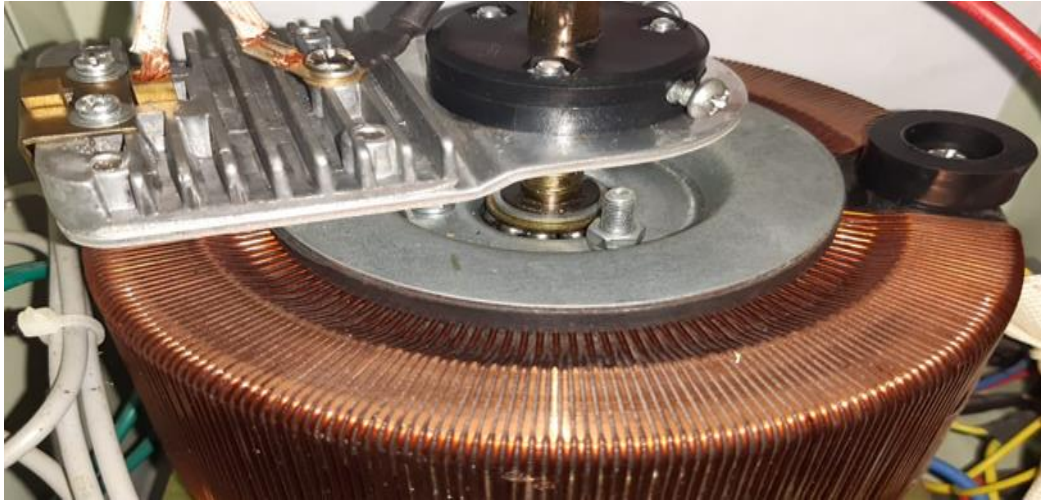
Figura 21. Mecanismo del Transformador Toroidal
