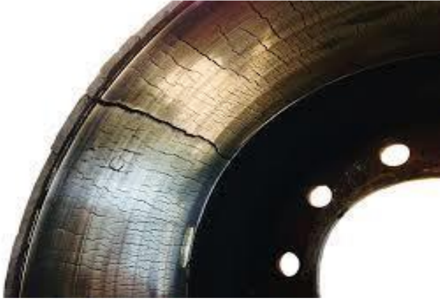
Figura 12. Tambor agrietado por el calor generado en la fricción (KashimaUniversity, 2017).
