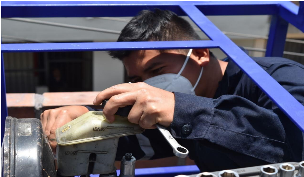
Figura 17. Montar el servofreno.
