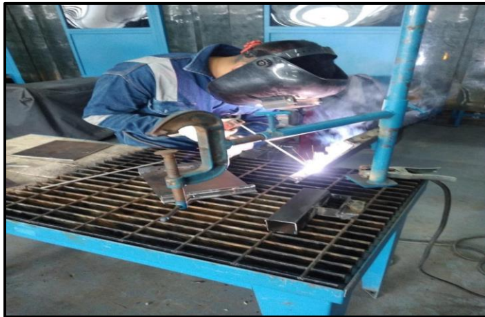
Figura 17. Fabricación de la caja porta cuchillas
