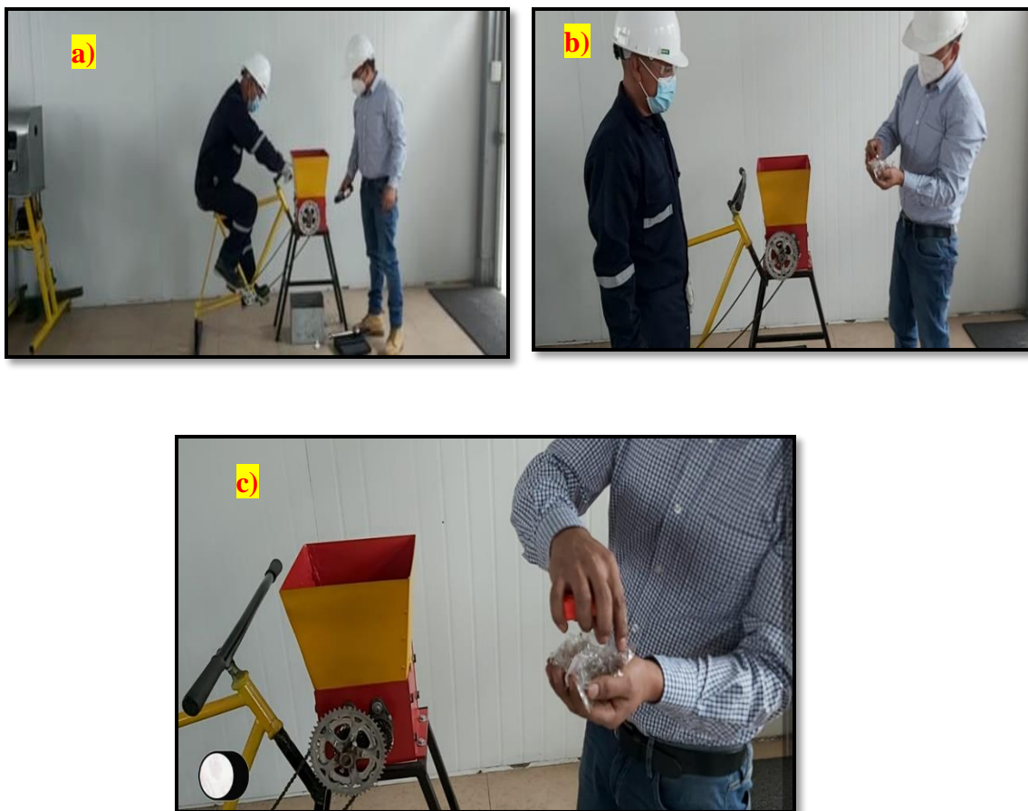
Figura 27. Pruebas de funcionamiento. a) Operación de la máquina. b) Recojo de producto final. c) Medición de PET.
