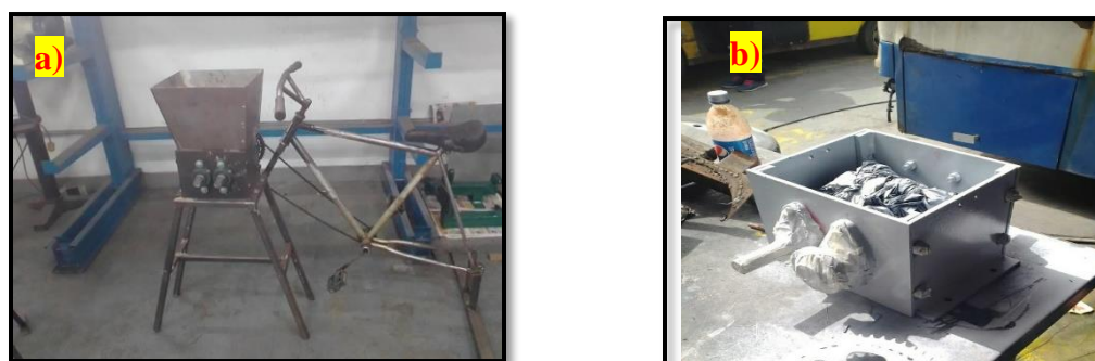
Figura .25. Procesos de pintado. a) Máquina sin pintar, b) Aplicación de pintura en la caja.
