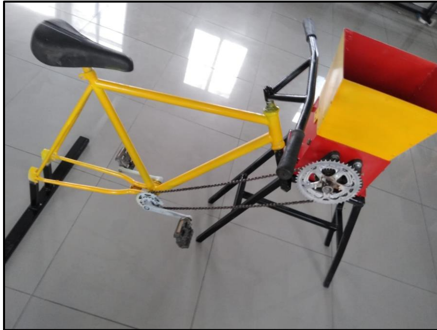
Figura 3. Sistema de transmisión Piñón - Catalina
