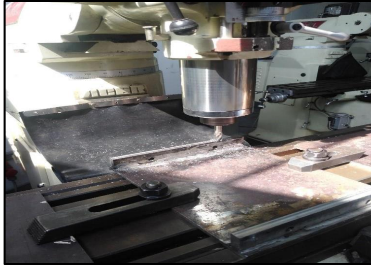
Figura 19. Fabricación de pared soporte de la chumacera
