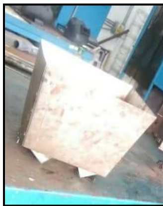
Figura 22. Fabricación de tolva.
