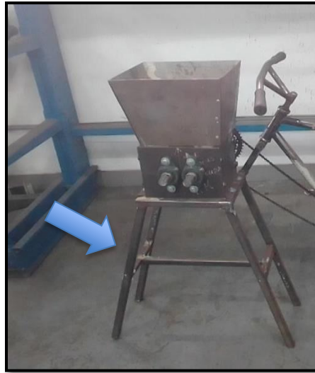
Figura 18. Fabricación del soporte de la caja porta cuchillas.
