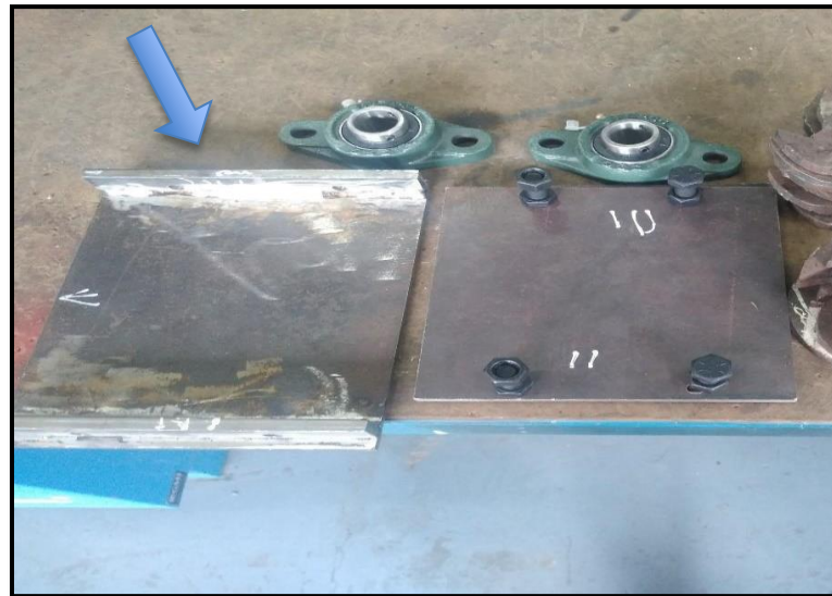
Figura 20. Fabricación de pared lateral de la caja
