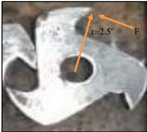
Figura 2. Diagrama de fuerza y radio para calcular el torque
