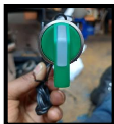
Figura 38. Interruptor de marcha y parada
