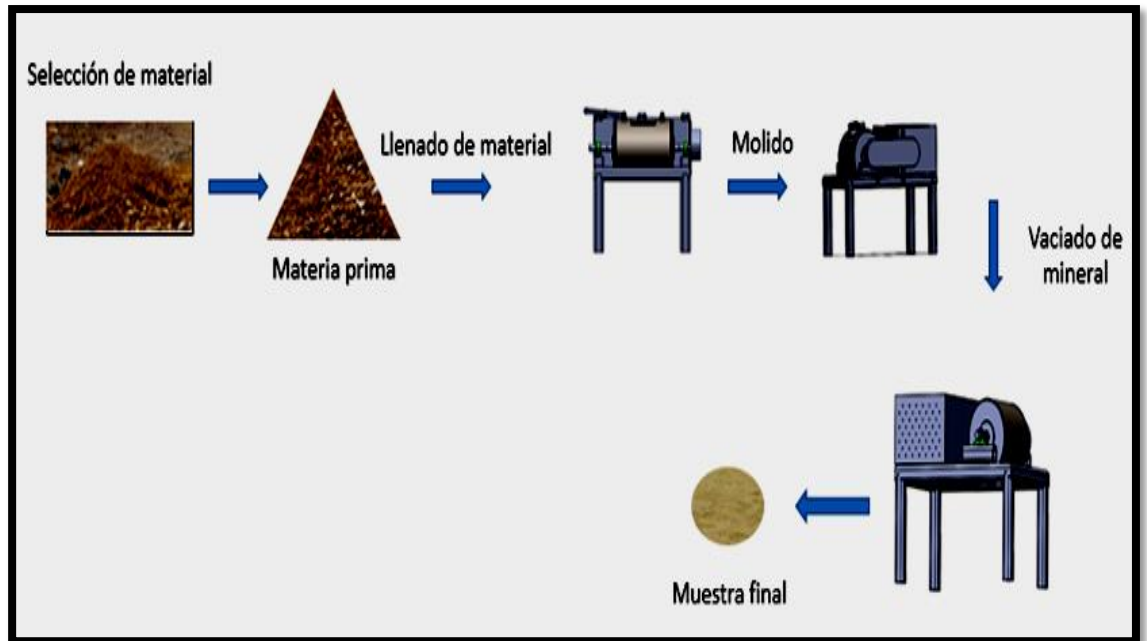
Figura 47. Funcionamiento del molino de bolas.
