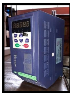
Figura 37. Variador de frecuencia
