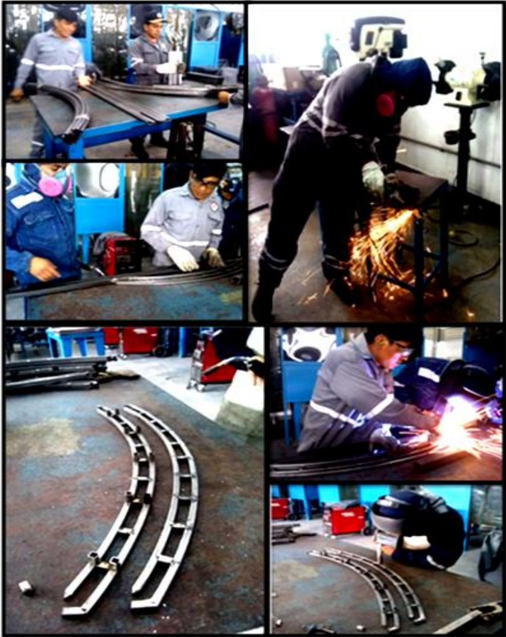
*Figura 27. Construcción de vigas y viguetas del techo arqueado*
