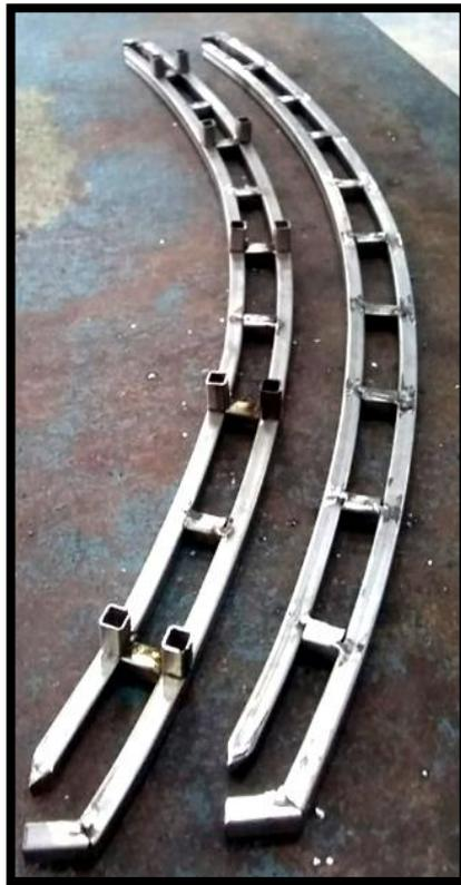
*Figura 14.* Vigas y viguetas del techo
