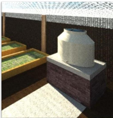
figura 10: Tanque de 600L
