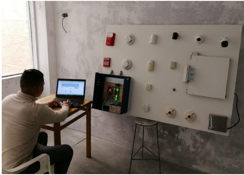
Figura 31. Prueba de enlace de la plataforma SCADA, Ubidots, tarjeta de control y dispositivos.
