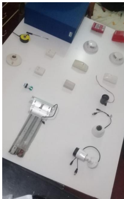
Figura 6. Dispositivos del sistema de seguridad electrónica
