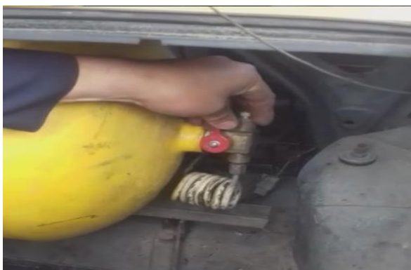
Figura 23. Rolado de la cañería
