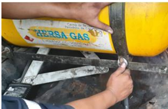
Figura 21. Fijando la cuneta
