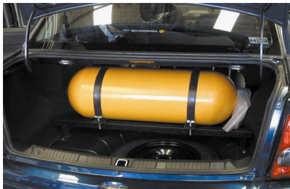
Figura 9. Dispositivo de sujeción del depósito de GNV
