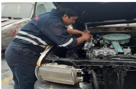
Figura 33. Instalando circuito eléctrico de GNV
