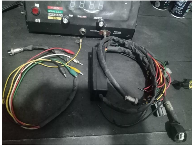
Figura 35. Modulo probador de bobinas terminado
