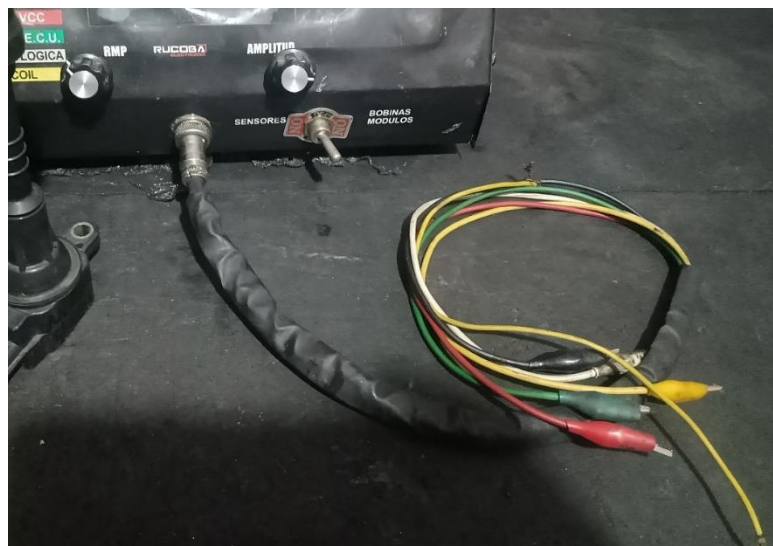
Figura 34. Ramal con caimanes para comprobar bobina de diferentes marcas
