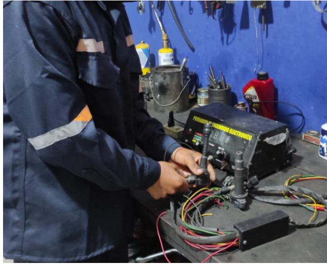
Figura 39. comprobación de los conectores de bobina
