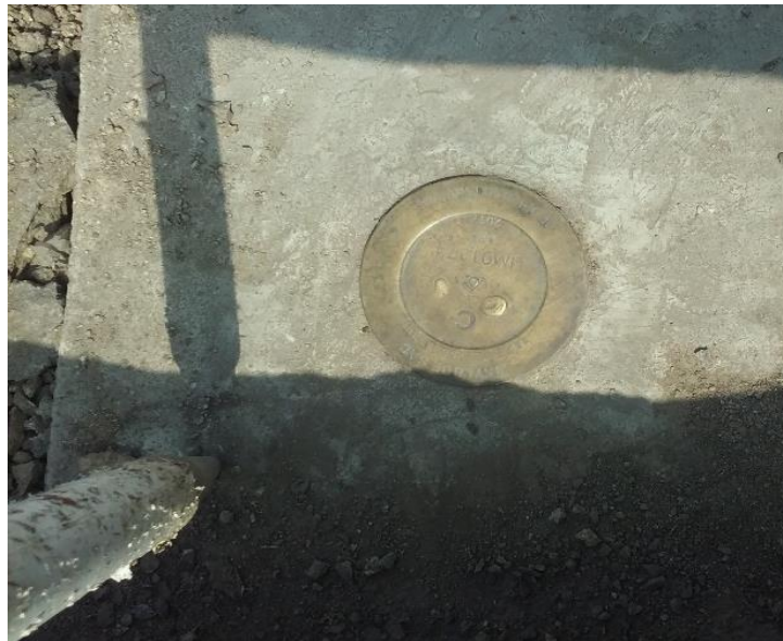
Foto N° 02: Placa de bronce del punto de control LIMO1074, para la orientación de la estación total.
