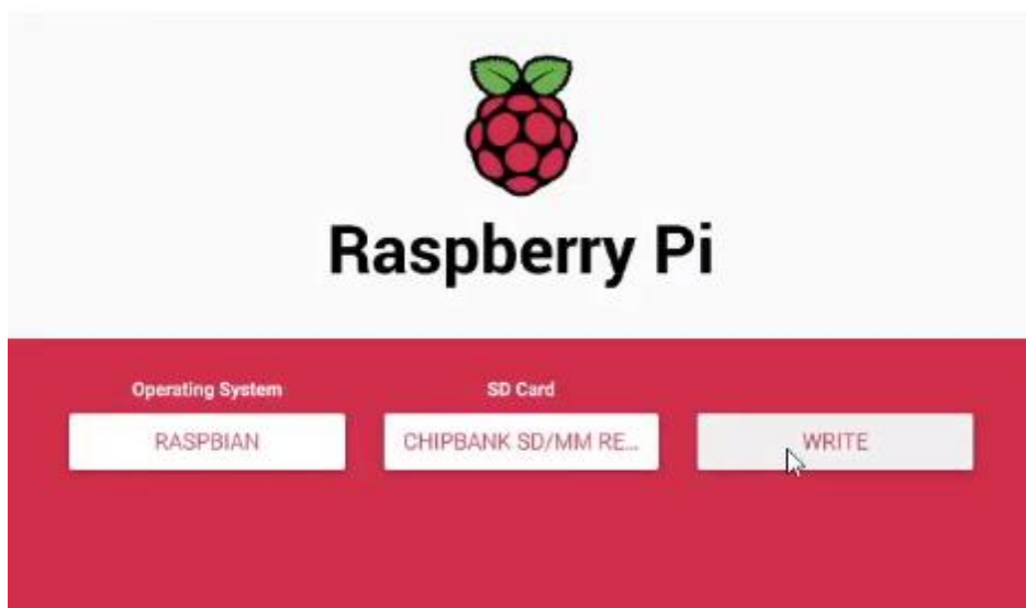
Figura 18. Cargar sistema operativo a la tarjeta SD.
