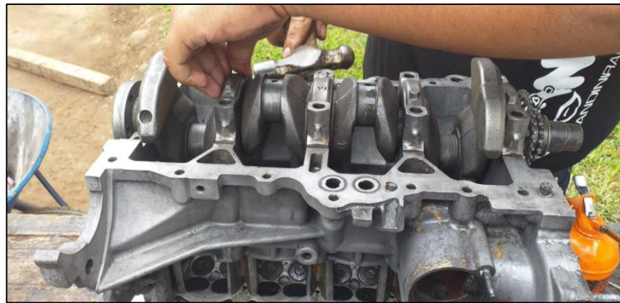
Figura 19. Colocar las bancadas en el cigüeñal.
