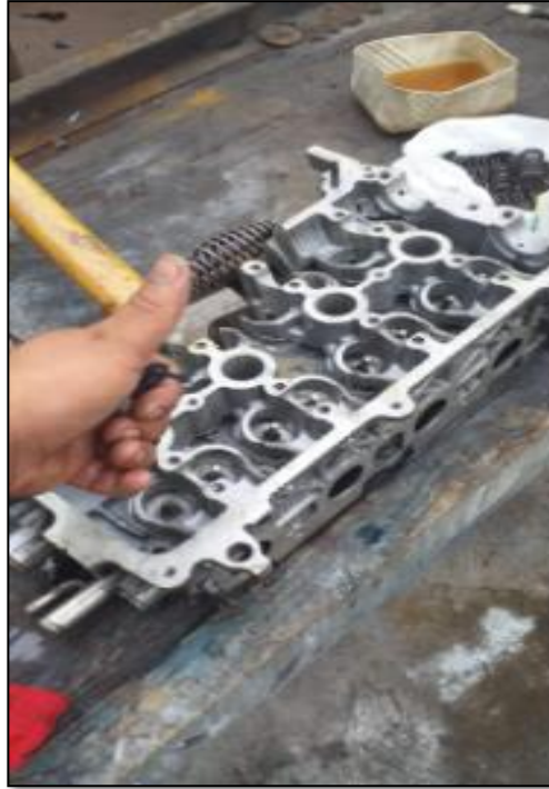
Figura 17. Montaje de las válvulas y las guías.
