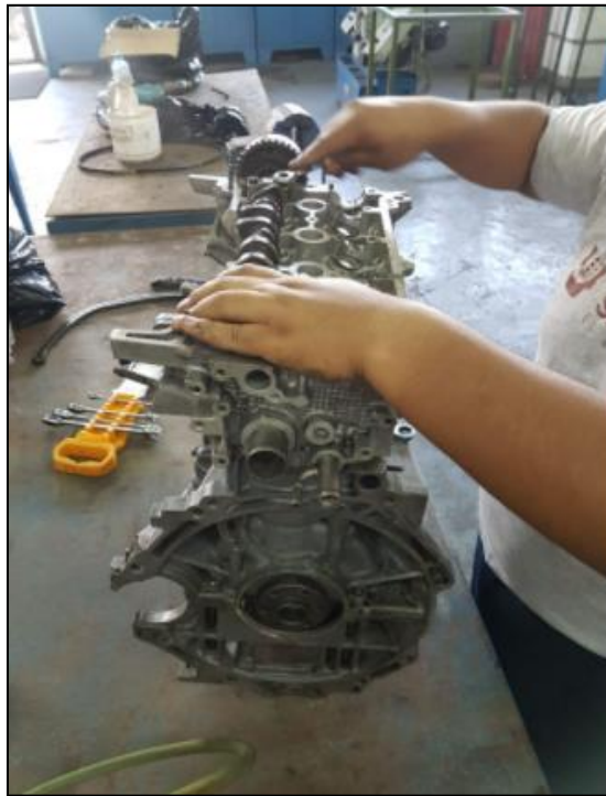
Figura 20. Montaje del eje de levas.
