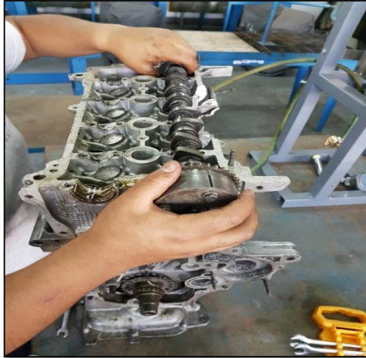
Figura 11. Retirada de eje de levas.
