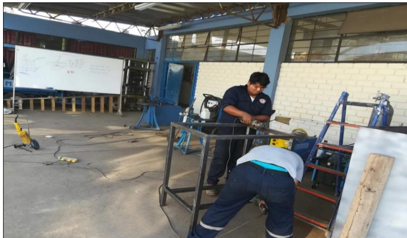
Figura 24. Desbaste de rebaba de la soldadura
