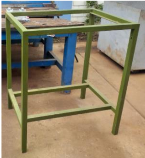
Figura 25. Pintado de la estructura base
