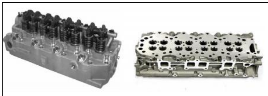
Figura 4. Vista superior e inferior de la Culata. (OTERO, 2017)
