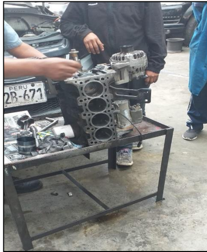
Figura 13. Extracción de los pistones.
