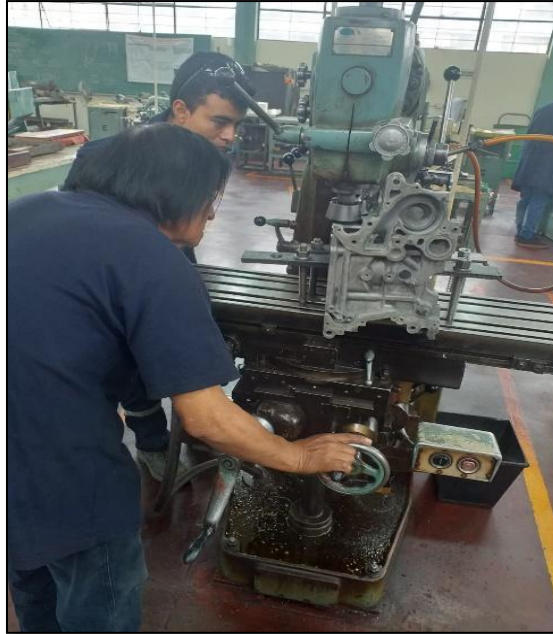
Figura 15. Rectificado del motor en la fresa.
