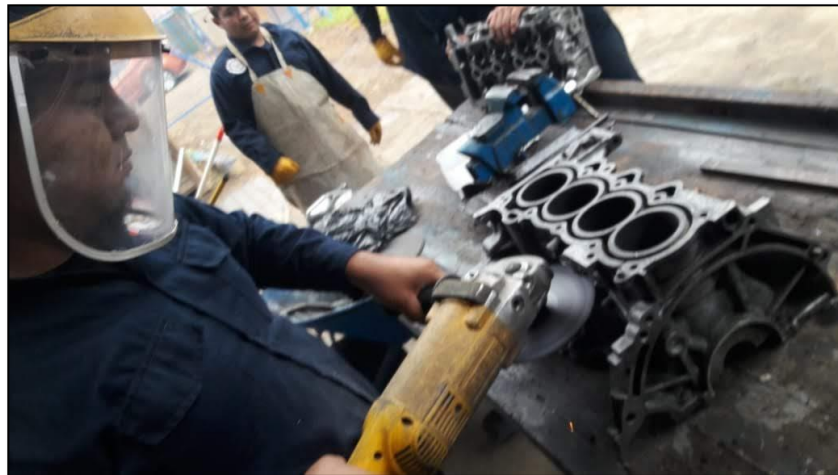
Figura 14. Seccionado del motor.
