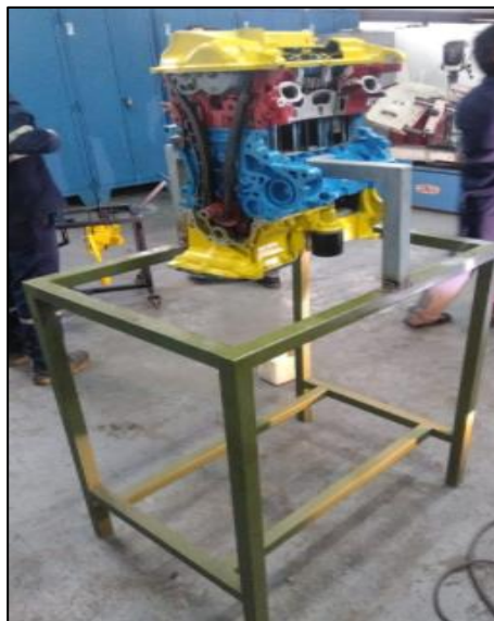
Figura 26. Montaje del motor en la estructura
