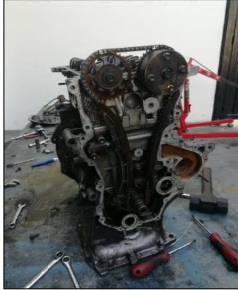
Figura 21. Montaje de cadena de distribución
