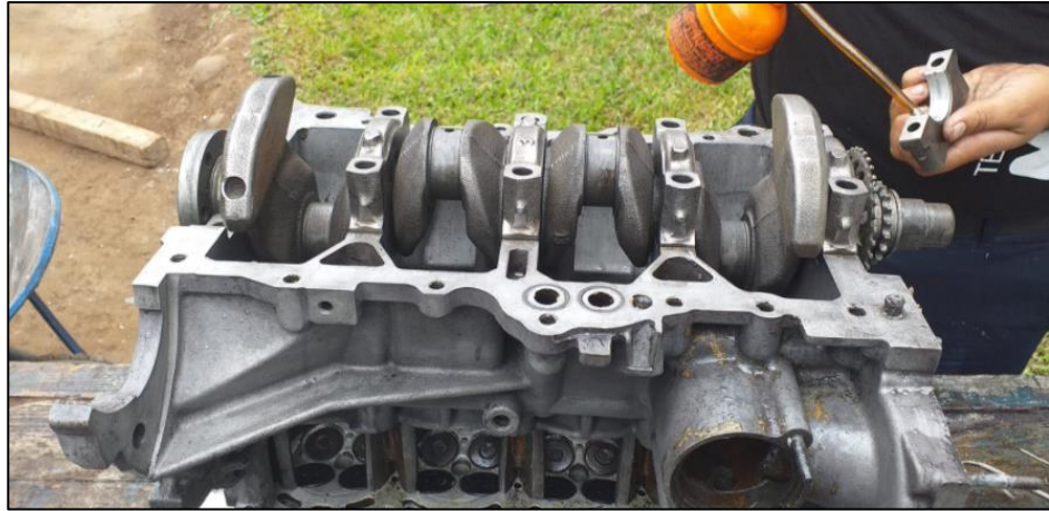
Figura 18. Lubricando las bancadas del cigüeñal.
