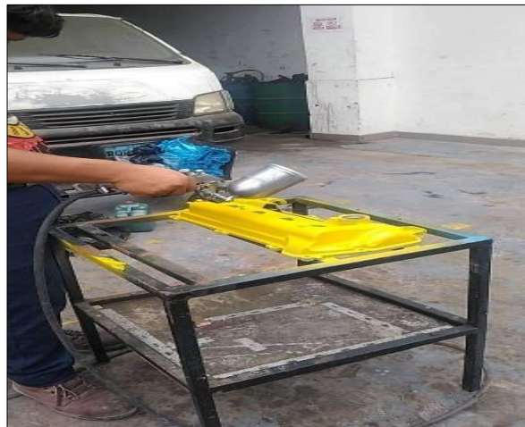
Figura 22. Pintado de la tapa de culata.
