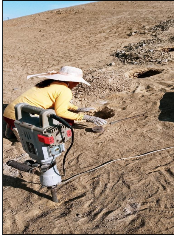
Figura 2. Ahoyado con el martillo demoledor.
