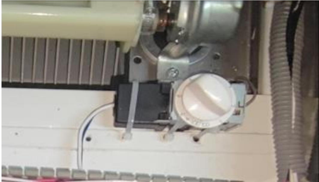
Figura 18. Se estableció una ubicación específica para el control y ajuste de la temperatura en la hielera VENTUS.
