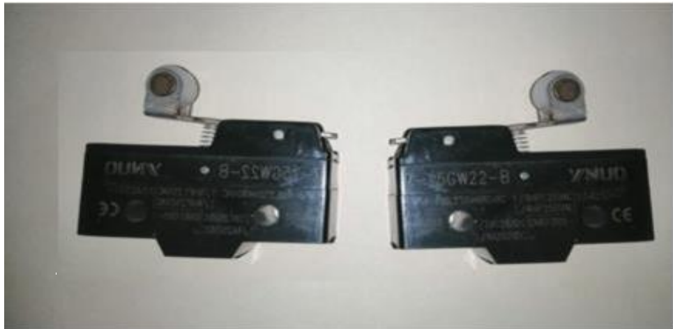
Figura 9. Final de carrera de 220 VAC - 24VDC.
