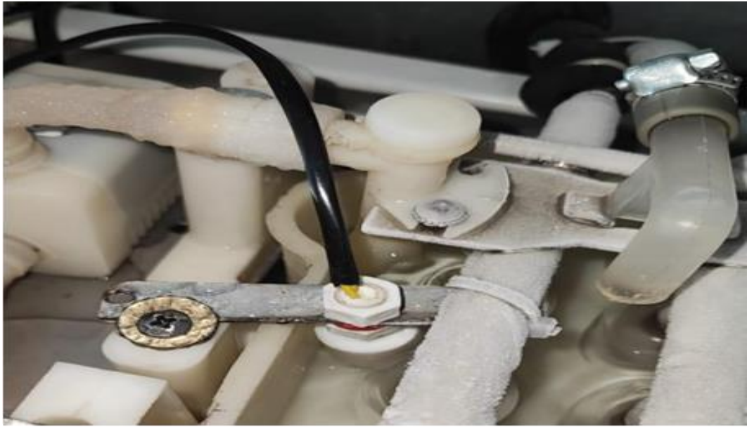
Figura 14. Se procedió a la instalación del sensor de nivel boya y se realizaron los ajustes necesarios para asegurar su correcto funcionamiento.
