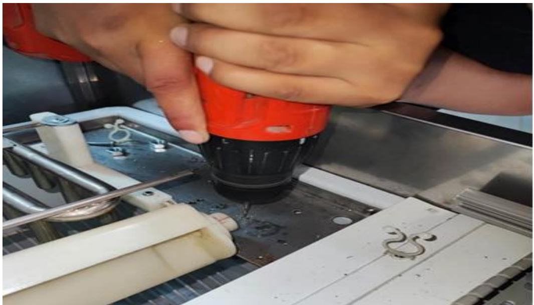
Figura 19. Se preparó la base donde se fijaría el motor en la hielera VENTUS.
