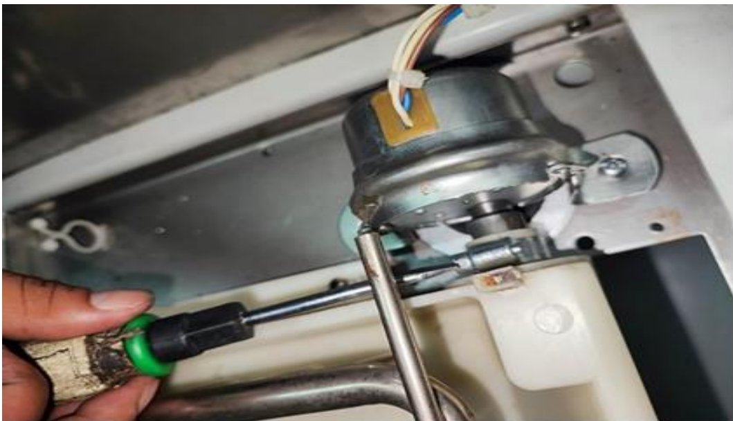
Figura 21. Se realizó un ajuste previo y calibración tanto del motorreductor como de la bandeja de agua en la hielera VENTUS.
