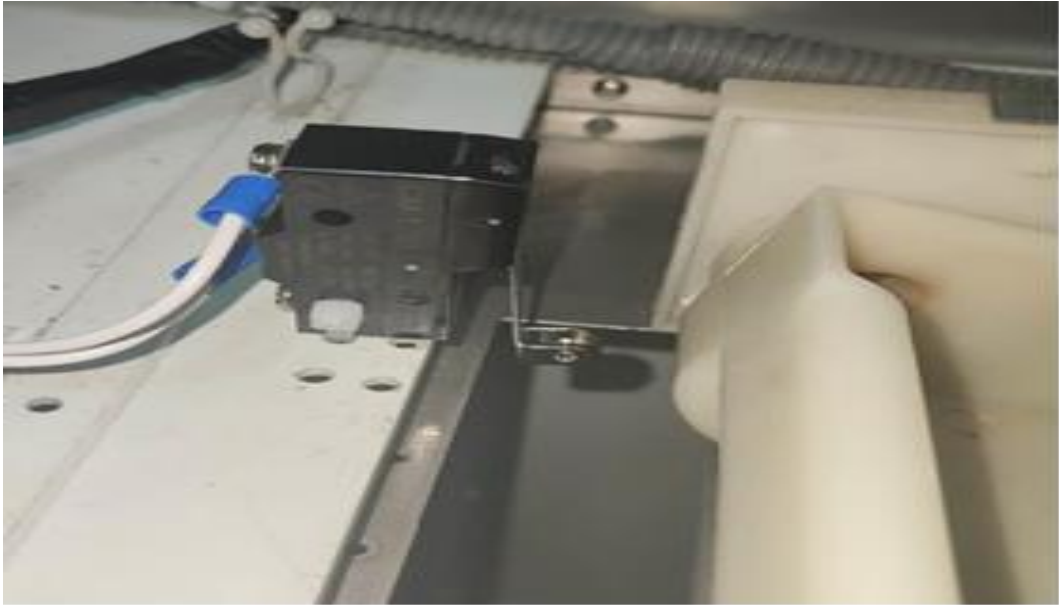
Figura 16. Se ajustó el final de carrera para la detección de la bandeja en la parte inferior de la hielera VENTUS.
