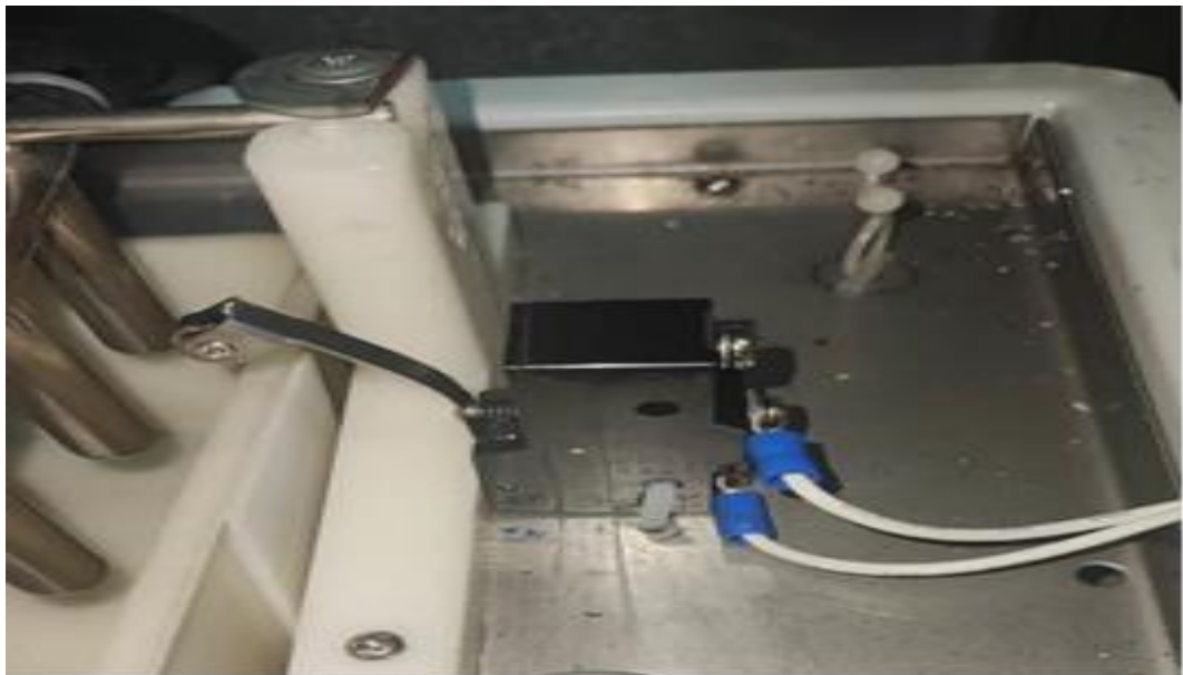
Figura 15. Se ajustó el final de carrera para la detección de la bandeja en la parte superior de la Hielera VENTUS.
