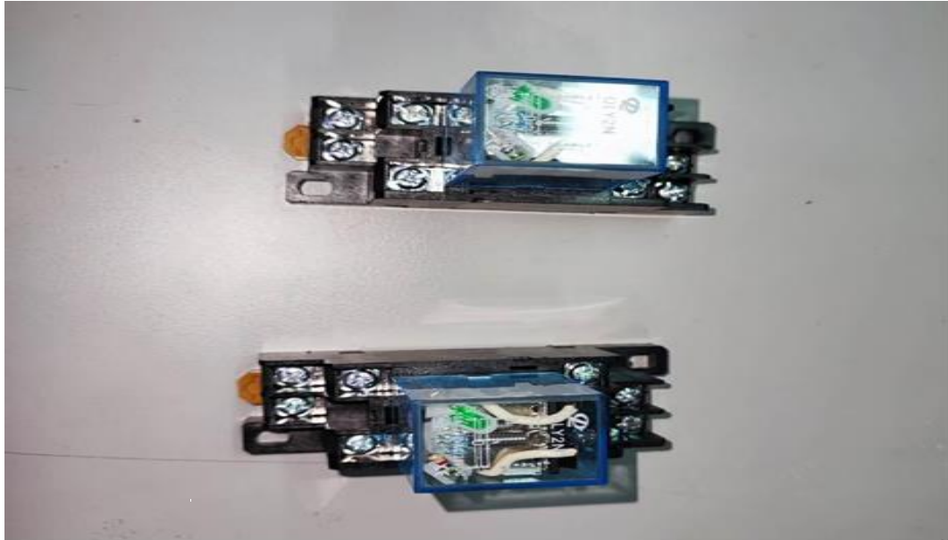
Figura 7. Relay con bobina 220 VAC – señal 24 VDC
