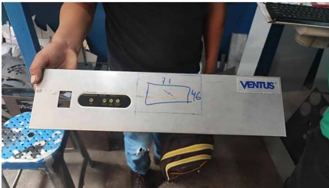
Figura 23. Se llevaron a cabo las mediciones necesarias para el control de IOT y se creó el marco correspondiente en el tablero de control de la hielera VENTUS.
