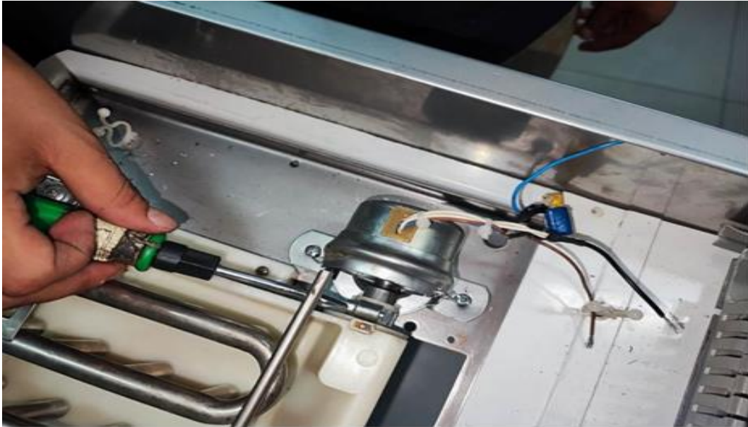
Figura 22. Se completó la instalación del motor reductor y la bandeja de agua en la hielera VENTUS.
